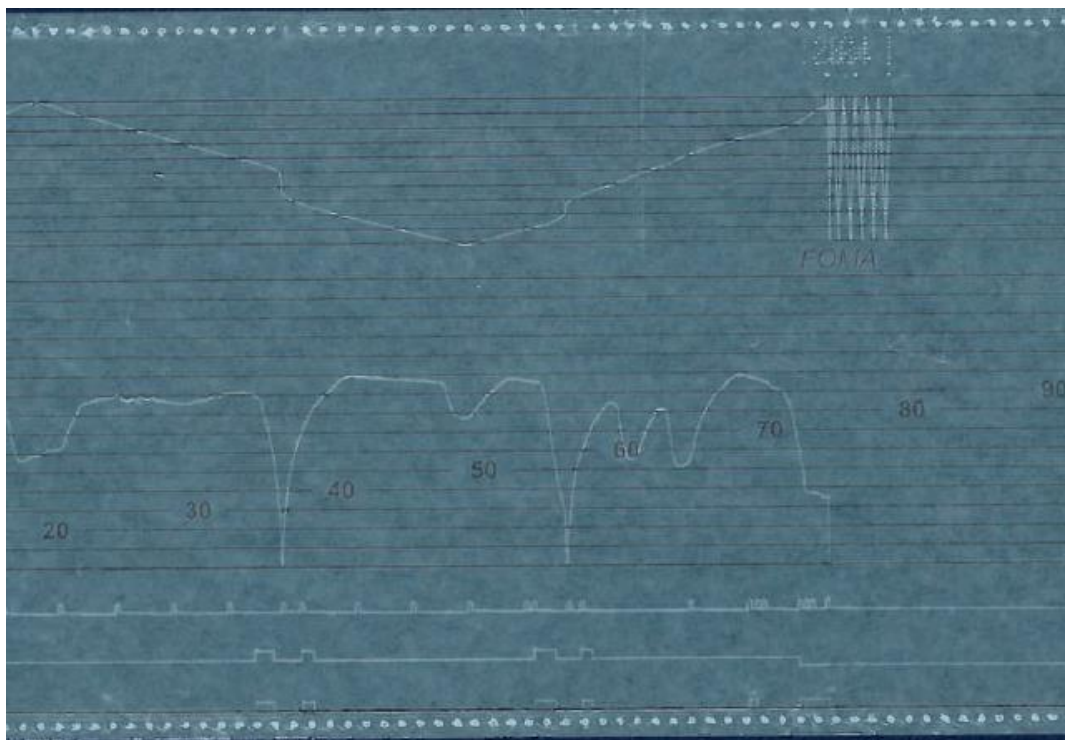
6. ábra: a mozdony menetíró regisztrátuma
