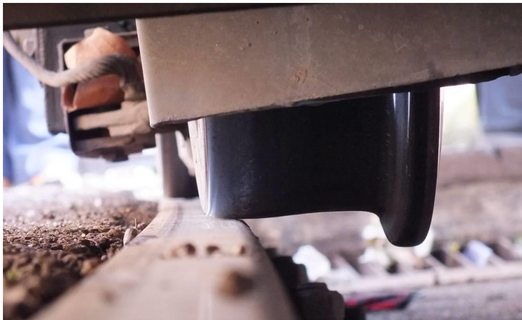
3. ábra: a 7. tengely belső sínszálon futó kereke
