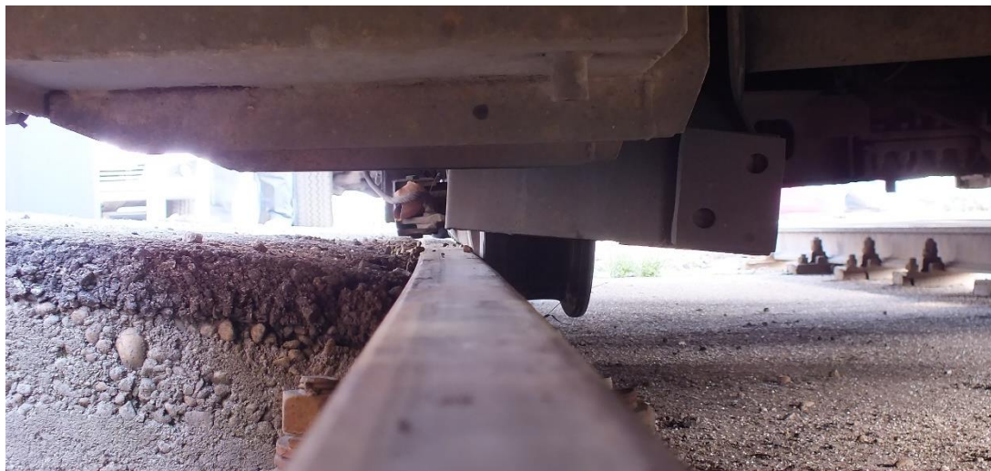
14. ábra: a helyreállításkor közéesett kerék
