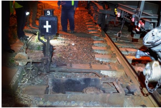
6. ábra: A váltójelző félállásában
