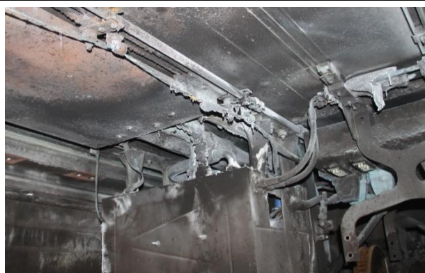
7. ábra: az alvázon a hőterhelés nyomai
