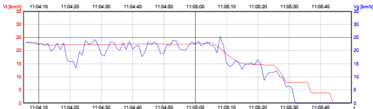
7. ábra: az MFB által rögzített sebességs adatok (vörös: Teloc, kék: GPS sebesség)
