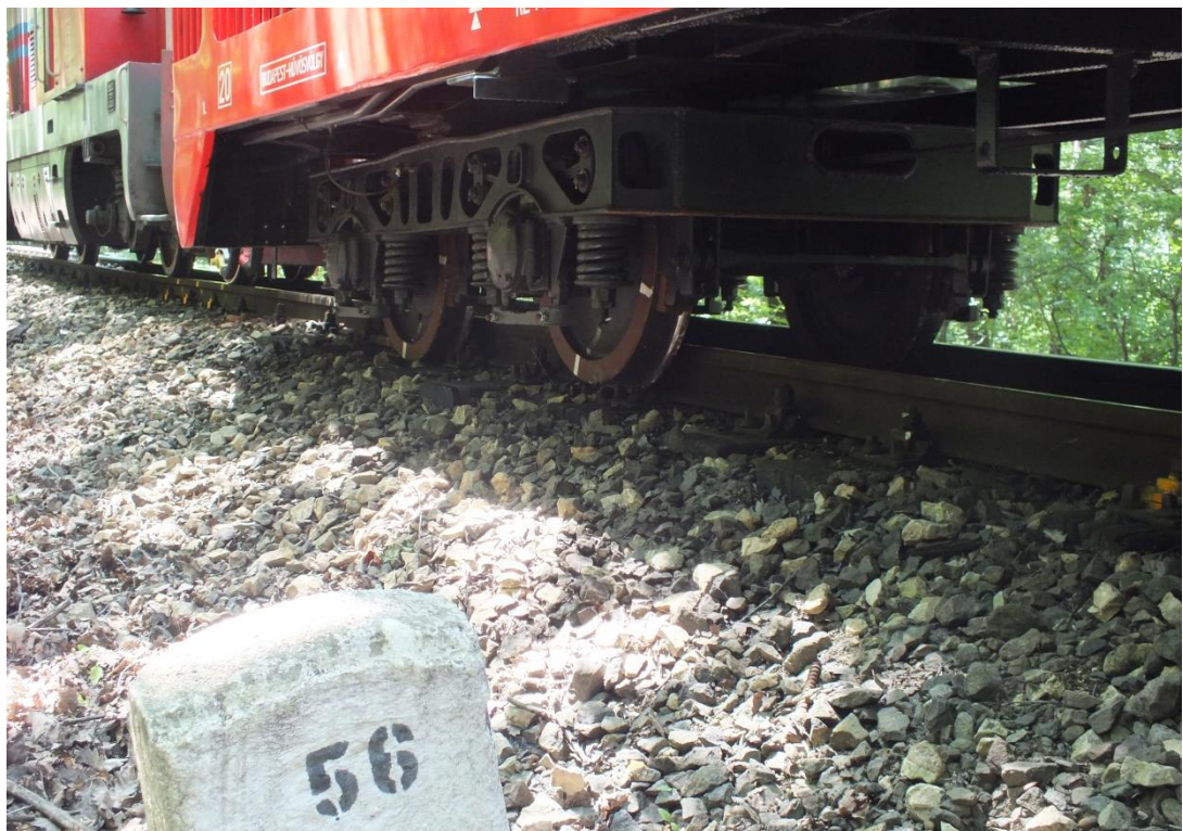
4. ábra: a kisiklott forgóváz
