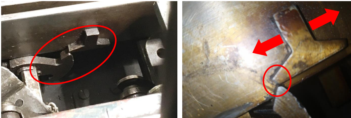
6-7. ábra: a mechanikus függés hiánya, ami a vágányúti kallantú elfektetését lehetővé tette
