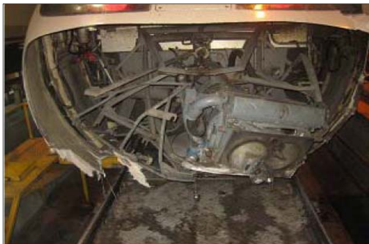
Daños en el carenado frontal y acoplamiento motriz 1 en material motor (fuente: Renfe Operadora)
