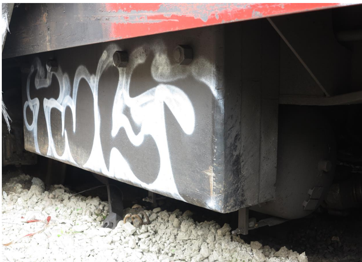
Figura 30 –Zavorra applicata lateralmente ai longheroni del telaio del locomotore
