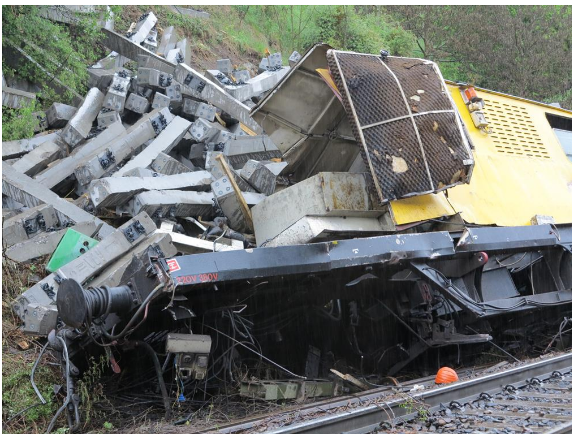
Figura 6 - Traverse fuoriuscite dai carri del rinnovatore in seguito all’urto
