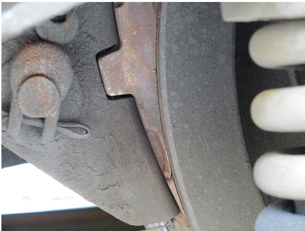
Figura 23 - Esempio di ceppo in condizioni anomale di lavoro e di usura
