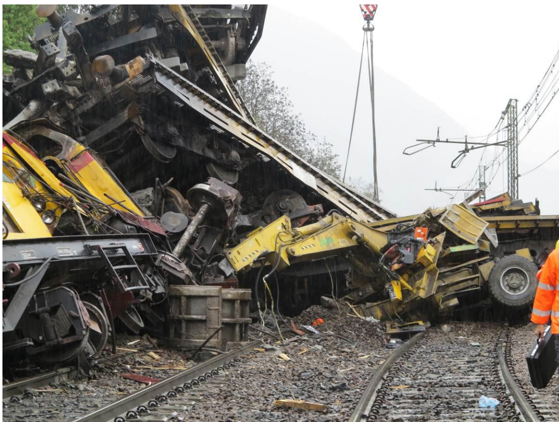
Figura 3 - Rotabili gravemente danneggiati nel punto dell'impatto. A sin. il locomotore
