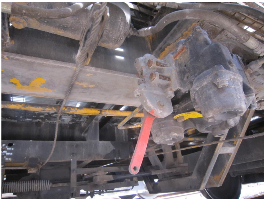
Figura 20 –Maniglia di isolamento freno del carro IT-RFI 170076-0 in posizione “isolato”
