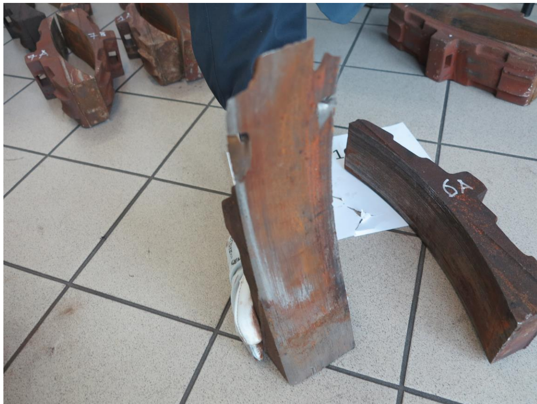
Figura 21 – Ceppi oltre il limite dell'usura in opera sul carro IT-RFI 170262-5
