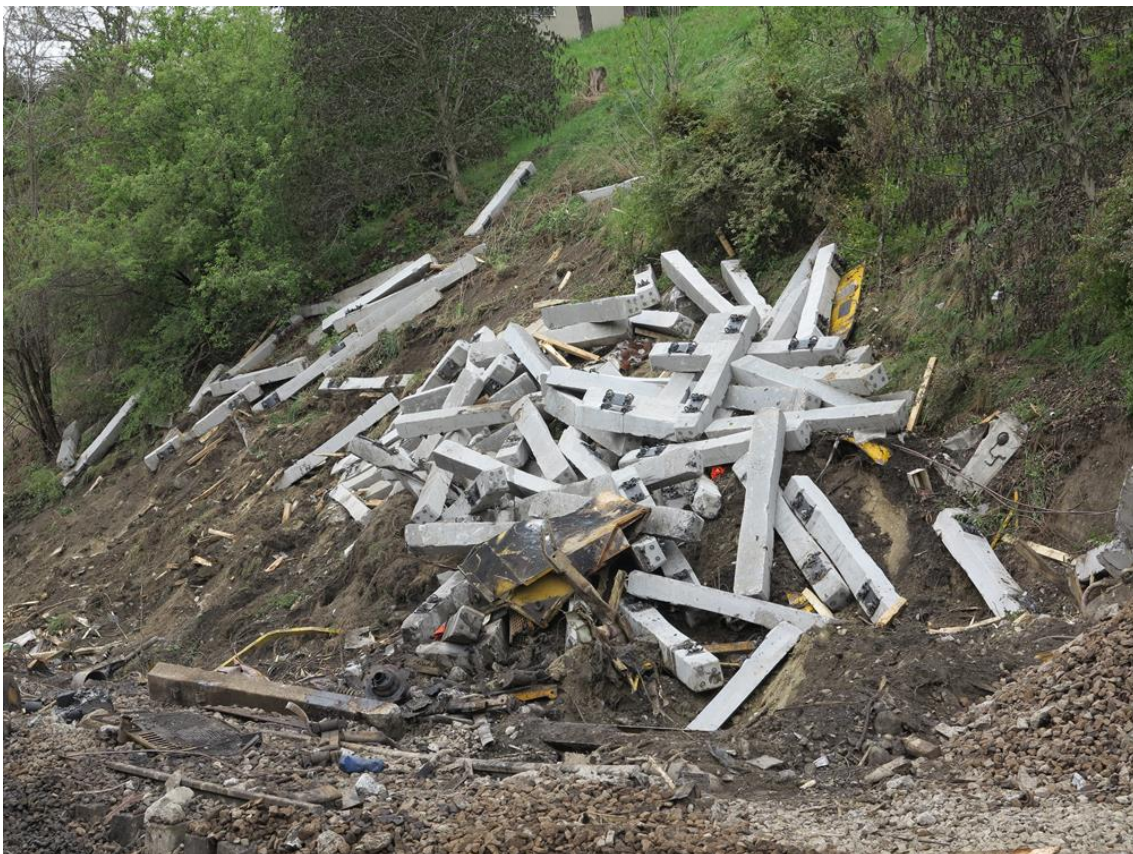
Figura 26 - Traverse cadute dai carri in seguito all'urto
