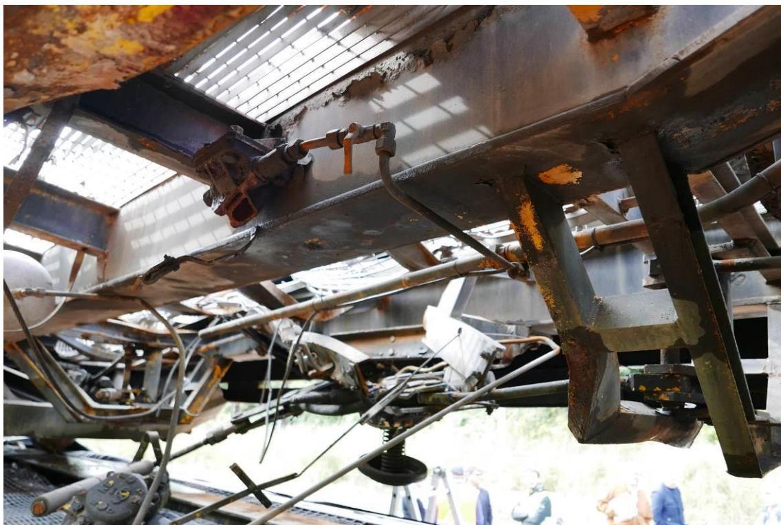
Figura 16 - Maniglia di isolamento freno del carro IT-RFI 170080-1 in posizione “isolato”
