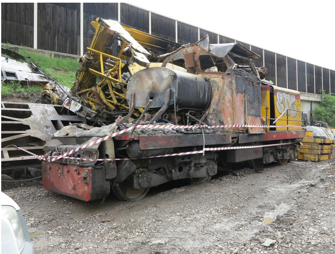
Figura 5 - Locomotore del convoglio “rinnovatore” dopo il parziale sgombero dei rottami. Notare la zavorra sotto la traversa di testa e tra i carrelli.
