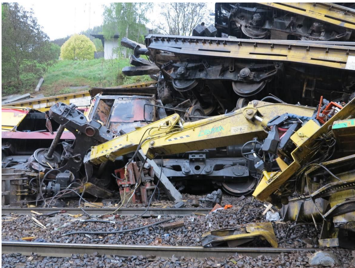
Figura 2 - Rotabili gravemente danneggiati nel punto dell'impatto
