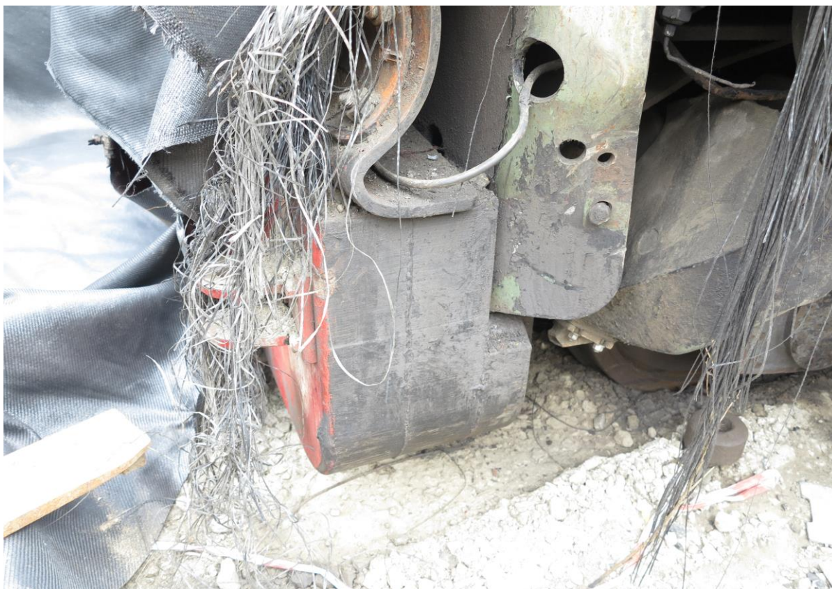
Figura 29 – Zavorra applicata sotto la traversa di testa del telaio del locomotore
