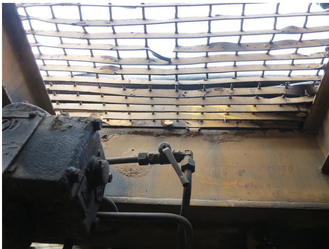
Figura 19 - Maniglia di isolamento freno del carro IT-RFI 170083-5 in posizione “isolato”
