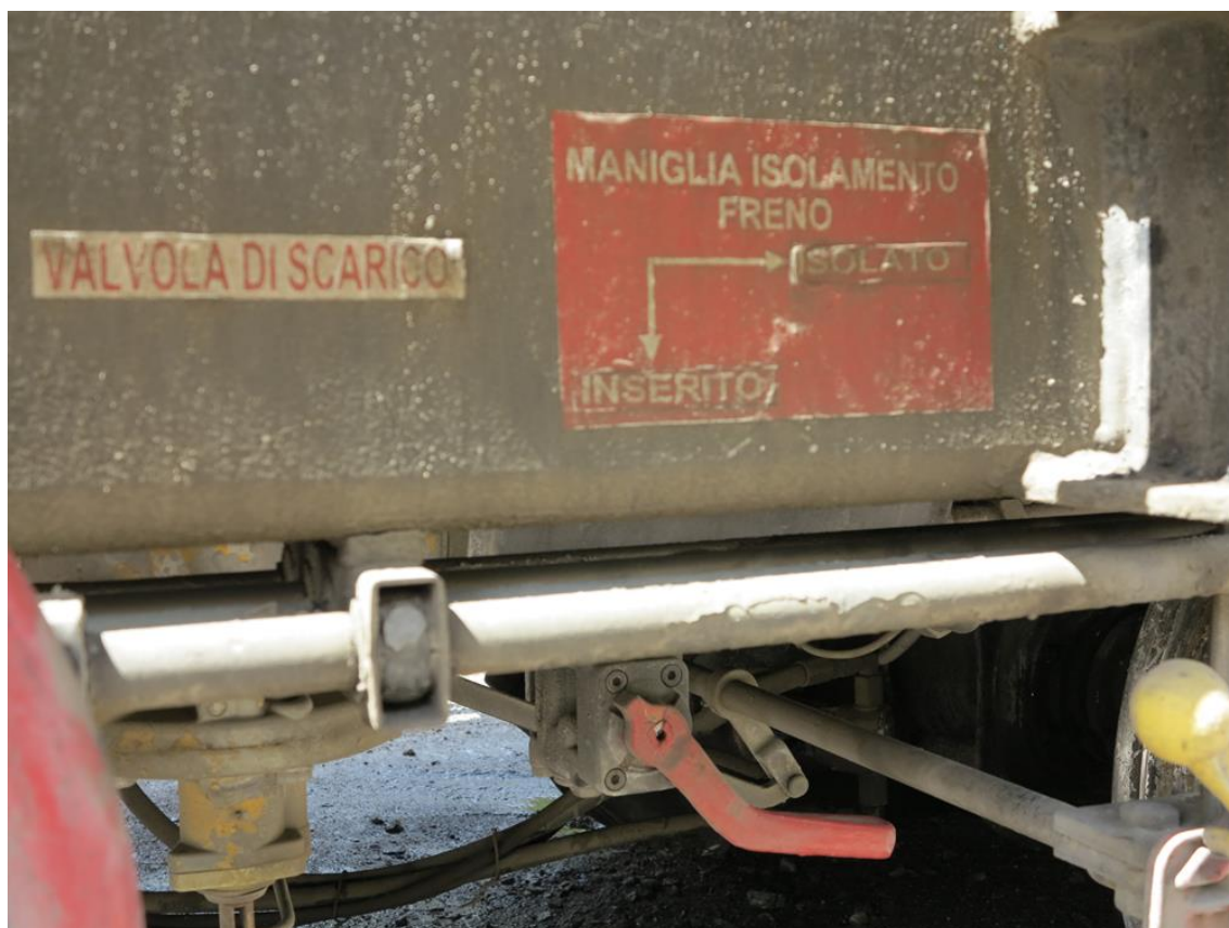
Figura 18 - Maniglia di isolamento freno del carro IT-RFI 170262-5 in posizione “isolato”
