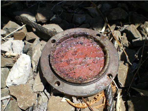
Figura 37 – Coperchio del 1° corpo boccola della sala montata US 6418164
