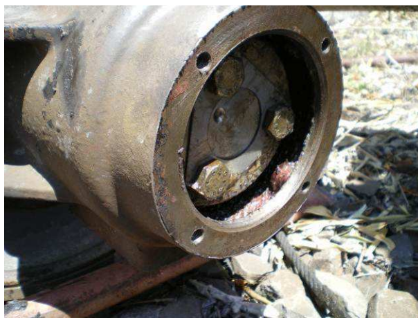
Figura 36 – 1° corpo boccola della sala montata US 6418164
