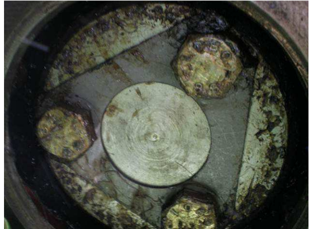
Figura 38 – 2° corpo boccola della sala montata US 6418164
