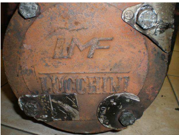
Figura 33 - Coperchio boccia della 1ª Sala montata del carro 23834363032-9 (US 6415939)
