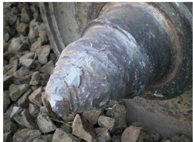
Figura 32 - Fusello della 1ª Sala montata del carro 23834363032-9
