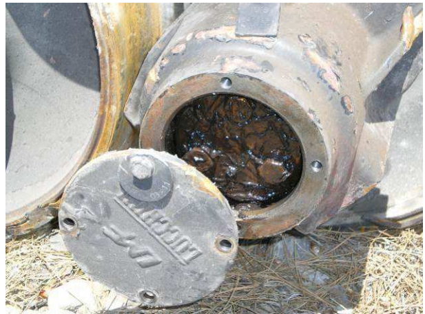
Figura 40 – Corpo boccola della sala montata US 64116689
