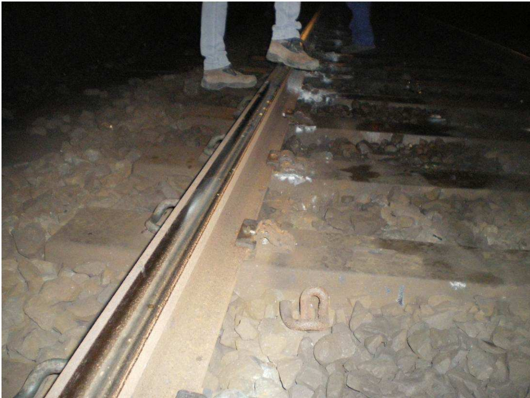
Figura 11- Segni di caduta sulle traverse
