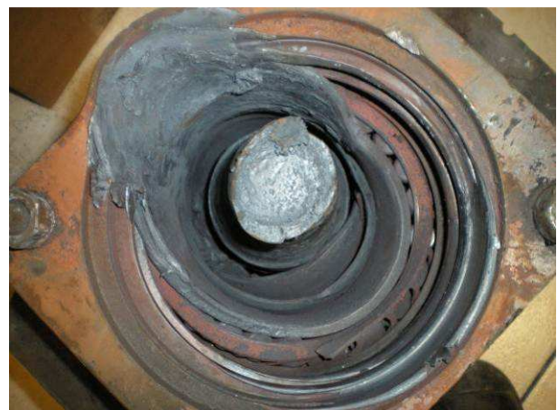
Figura 34 - Boccia 1ª Sala montata del carro 23834363032-9 (US 6415939)
