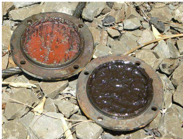
Figura 41 – Coperchi dei corpi boccola della sala US 6418164 (sinistra) e della sala US 64116689 (destra)
