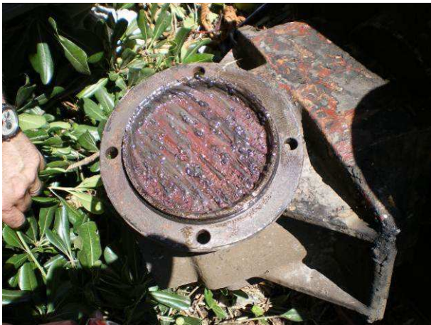
Figura 39 – Coperchio del 2° corpo boccola della sala montata US 6418164
