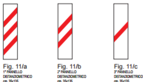
Figura 35 - Pannelli di avviso distanziometrico da un PL con barriere (fonte: Regolamento di esecuzione e di attuazione del Nuovo Codice della Strada)
