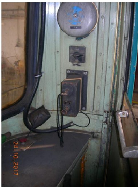
Figura 21 - Chiave di abilitazione del banco di guida cabina B (fonte Mercitalia Rail)
