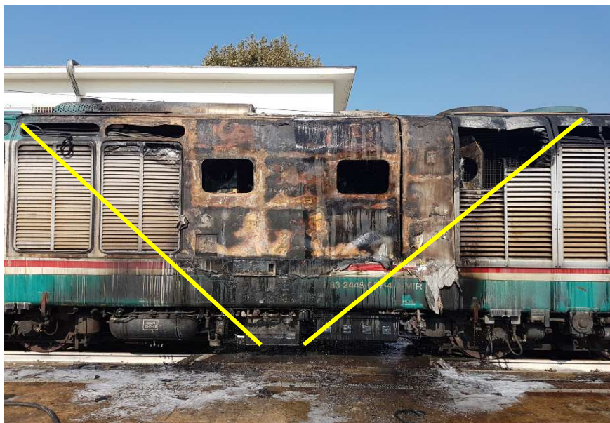
Figura 1 - Fiancata destra della locomotiva incidentata (fonte Mercitalia Rail)
