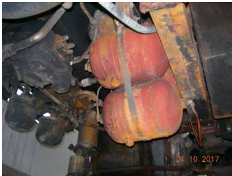
Figura 22 - Distributore, serbatoio di comando e relè TP-1 (fonte Mercitalia Rail)
