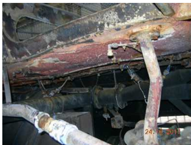
Figure 13 e 14 - Griglia di aerazione vasca motore e Tetto del comparto motore (fonte Mercitalia Rail)
