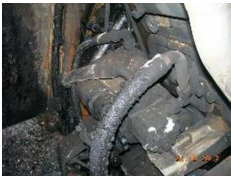
Figura 16 - Pompa Sauer dell'impianto idrostatico (fonte Mercitalia Rail)
