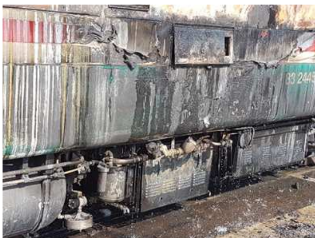
Figure 3 e 4 - Vano caldaia di preriscaldamento Webasto (fonte Mercitalia Rail)
