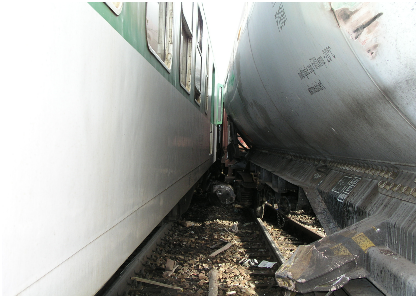
Foto 3 Poškozené DV s nebezpečným zbožím
