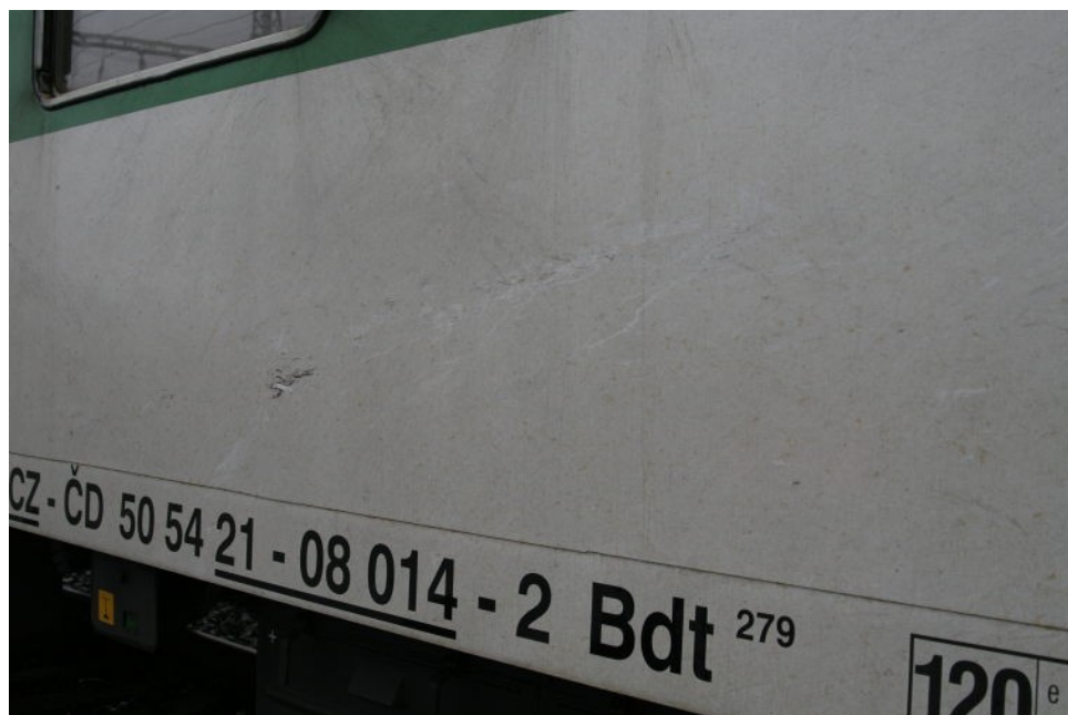
Foto 7.7 Stopy po střetnutí se silničním vozidlem na druhém taženém DV vlaku Os 6409 řady Bdt 279 50 54 21-08 014-2
