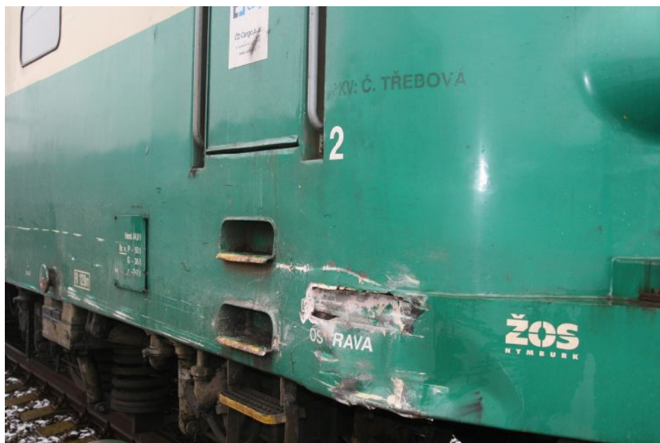
Foto 7.9 Stopy po srážce se silničním vozidlem na HDV vlaku Pn 65401 řady 130.032-6
