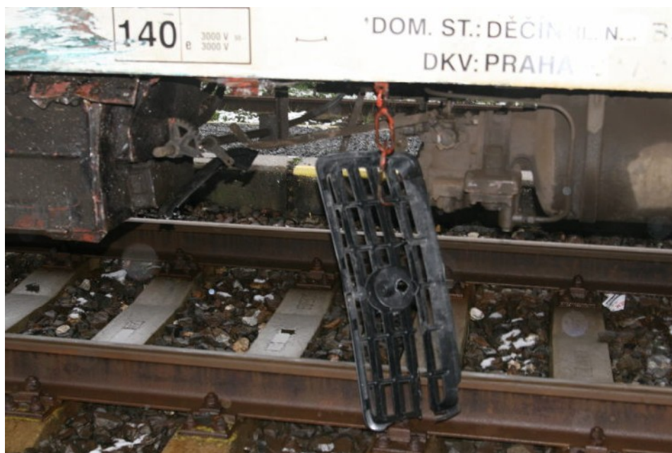
Foto 7.5 Mřížka z přední části silničního vozidla zavěšená na prvním taženém DV vlaku Os 6409 řady B 250 50 54 20-80 219-9
