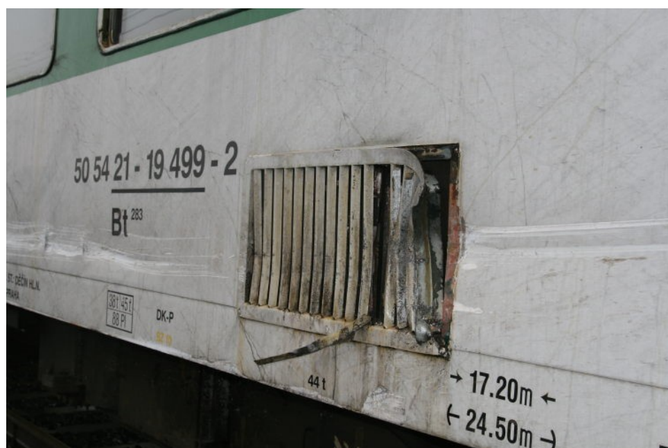
Foto 7.8 Stopy po střetnutí se silničním vozidlem na druhém taženém DV vlaku Os 6409 řady Bt 283 50 54 21-19 499-2
