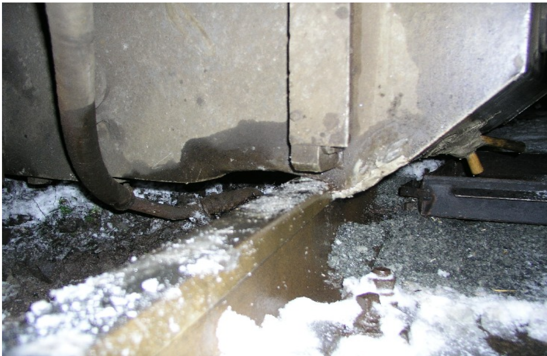
2. Pohled na poškozenou nádrž pohonných hmot HDV řady 742.126-6
