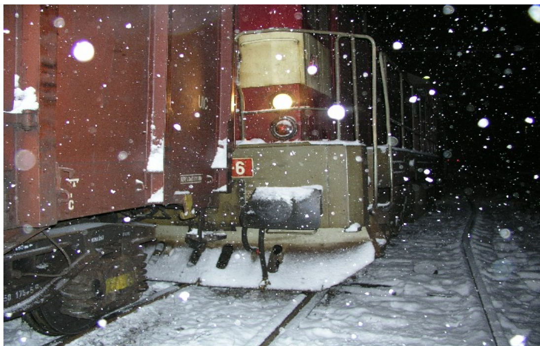
1. Pohled na hnací drážní vozidlo řady 742.126-6 jedoucí v čele vlaku Mn 80203 ve vykolejeném stavu za výhybkou č. 15 žst. Bystřice nad Olší
