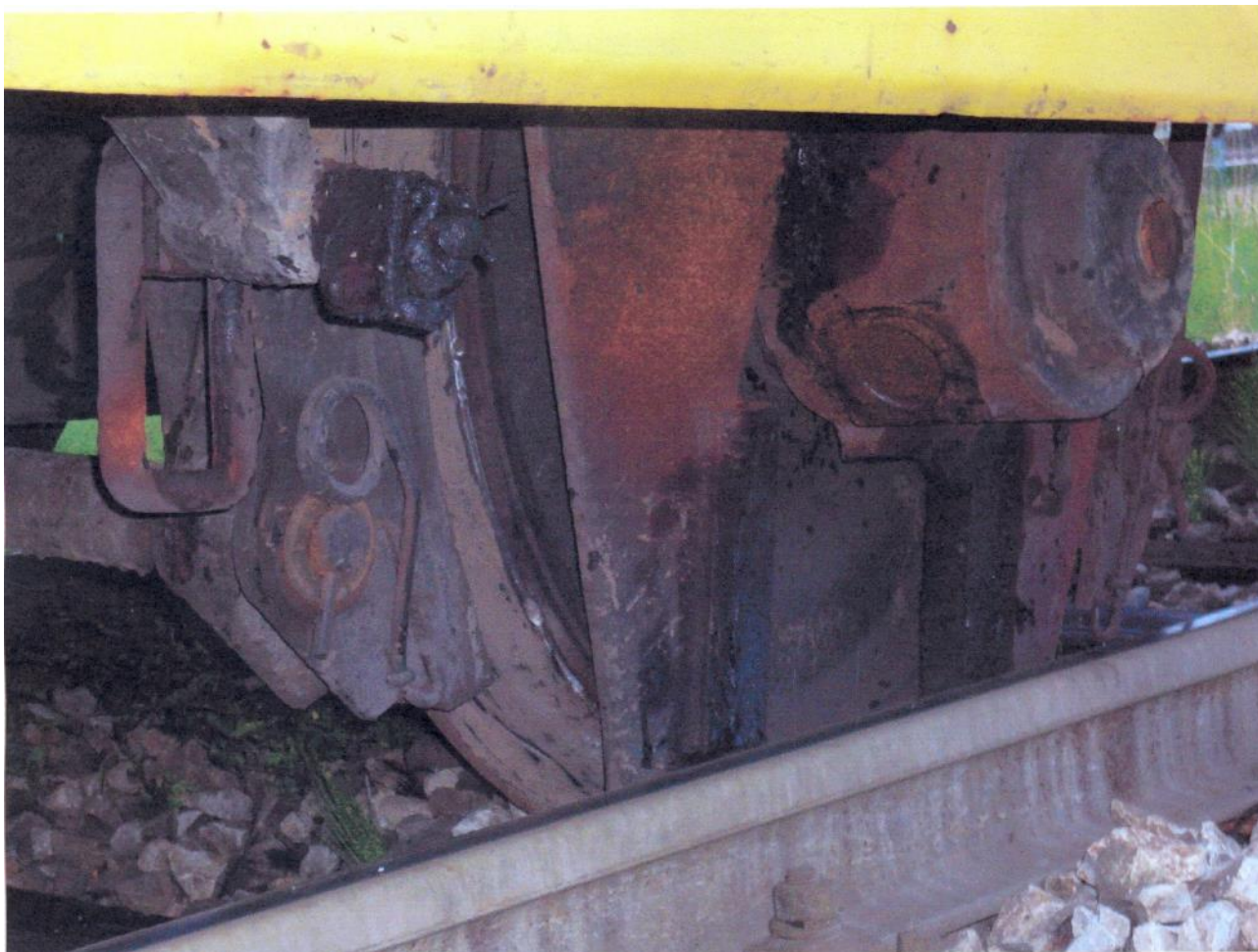
Slika 3 – Mjesto oštećenja na vagonu (izvor slike: HŽ Infrastruktura d.o.o.)
