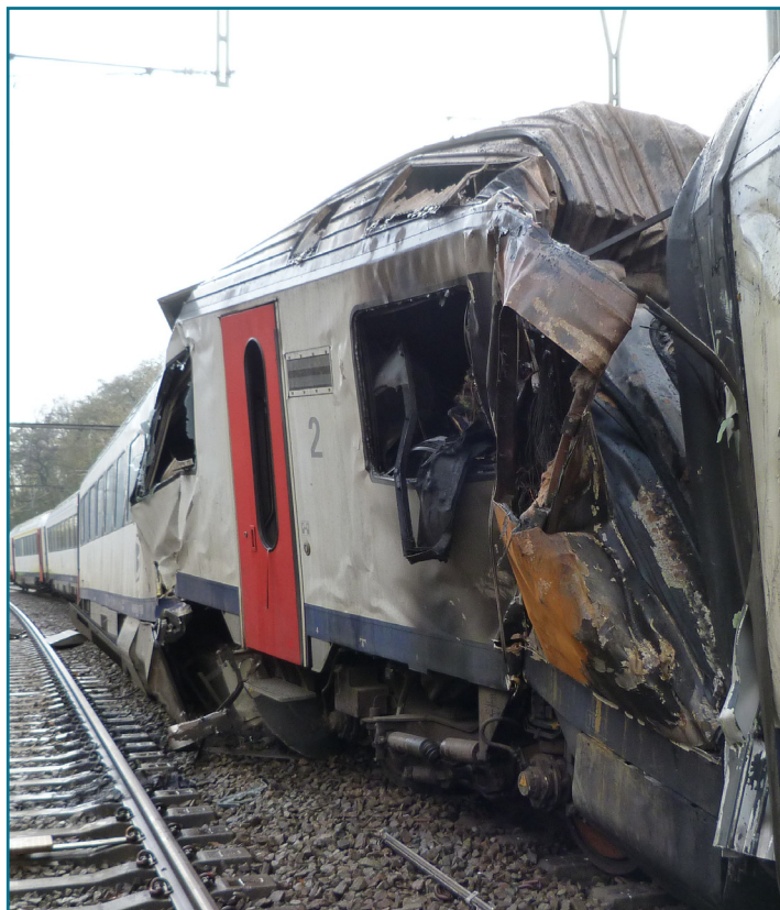
L'avant de la première caisse/voiture de l'AM449, avec les traces de l'incendie, entré en collision avec le train E940 à Bracquegnies.
