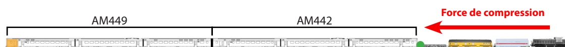
Illustration : automotrices AM449 et AM442 sur lesquelles une force de compression est exercée par la locomotive du train de secours.
