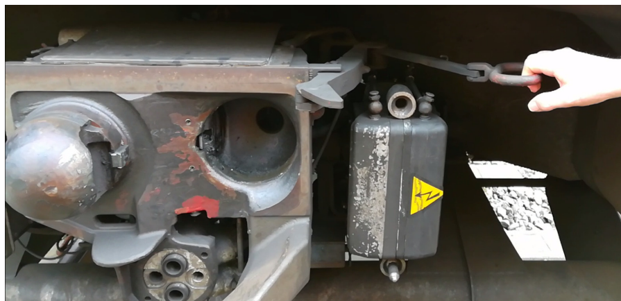
Illustration de la poignée de désaccouplement manuel.
