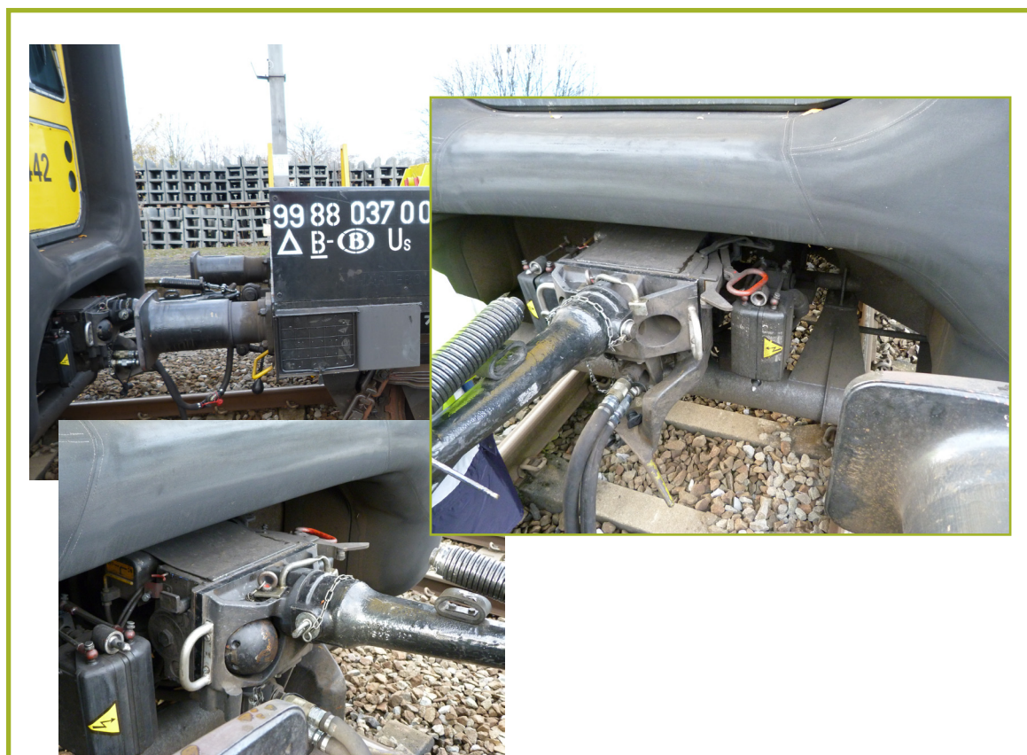
Illustration : attelage de secours reliant le wagon plat du train de secours à l'arrière de l'AM 442.
