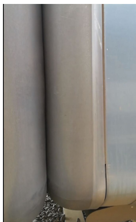
Illustration : boudins de 2 automotrices pressés l'un contre l'autre
