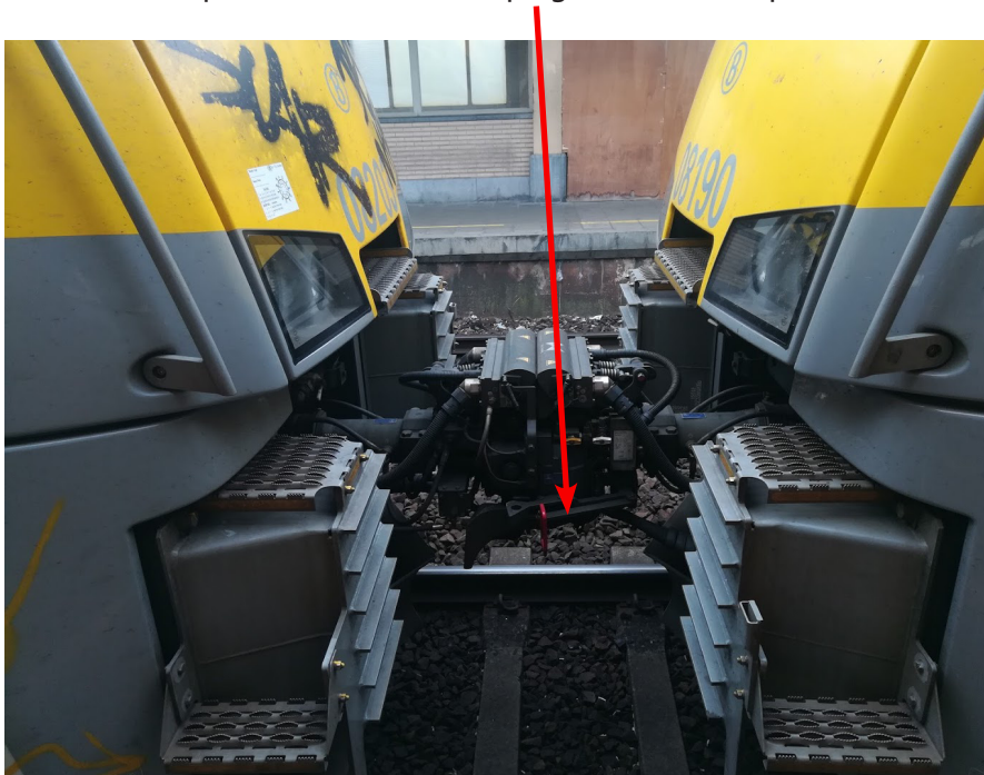
Illustration : 2 automotrices AM08 "Desiro" accouplées.
