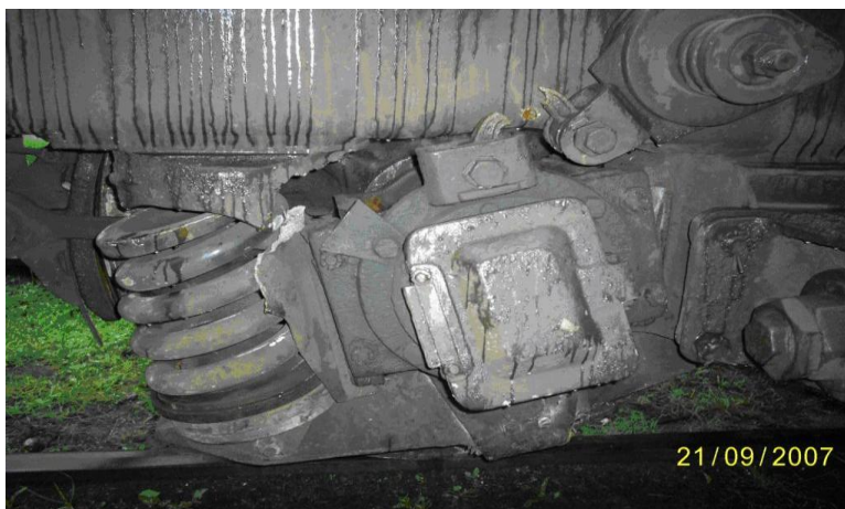
Mootorvaguni 3108 alusvankri nähtavad vigastused
