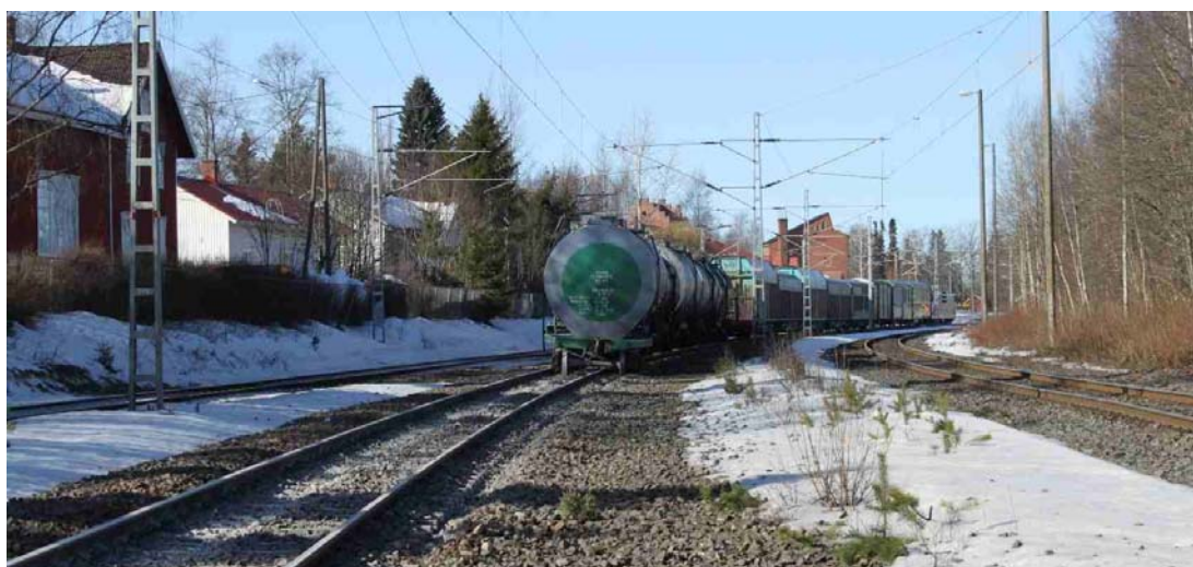
Kuva 4. Junan etupää, veturi ja 15 vaunua, jatkoivat jarrujohdon katkeamisen jälkeen vielä 314 metriä pitkin raidetta 041. Viimeisen vaunun takateli kulki suistuneena ja rikkoi ratapölkkyjä.
