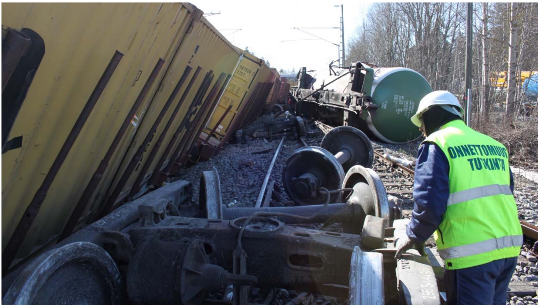
Kuva 5. Onnettomuudessa korjauskelvottomaksi vahingoittunut venäläinen säiliövaunu sekä vaunusta irronnut teli ja pyöräkertoja.
