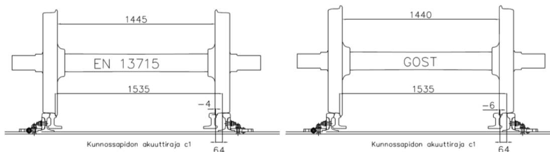
Kuva 19. Välykset Railexin kohdalla suomalaisella ja venäläisellä pyöräkerralla; pyörät kunnossapidon alarajalla, pyöränlaippojen väli nimellimitoissa ja vaihde kunnossapidon akuuttirajalla.
