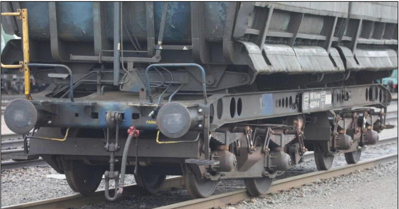
Kuva 12. Taimn-vaunu suistunut pyöräkerta Kouvolassa 12.1.2020. (Kuva: OTKES)
