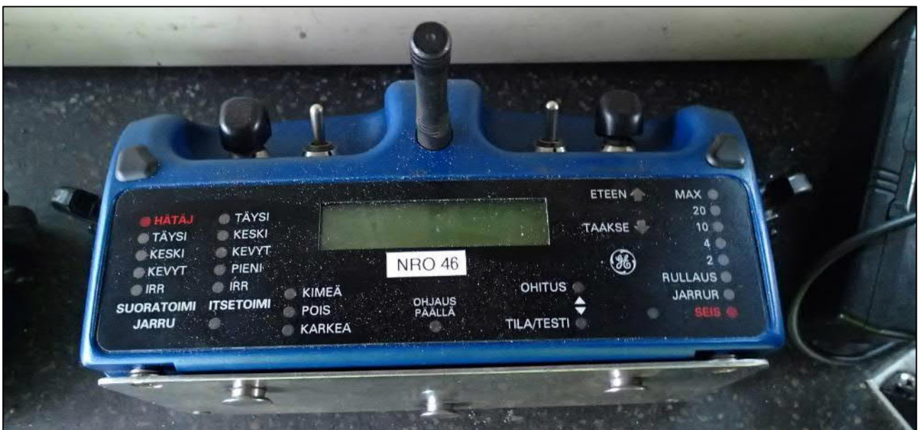
Kuva 31. GE Transportation Systems LOCOTROL-järjestelmän radio-ohjain, OCU. Ohjaimen vasemman reunan säätimellä ohjataan jarrutusta ja oikean reunan säätimellä veturin nopeutta. Hätäjarrutus tehdään kääntämällä ohjaimen vasemman reunan säädin täysin eteen. (Kuva: OTKES)
