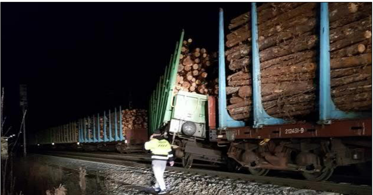
Kuva 8. Ylöjärven vaihteessa V001 22.10.2019 suistunut puutavaravaunu. (Kuva: Väylävirasto)
