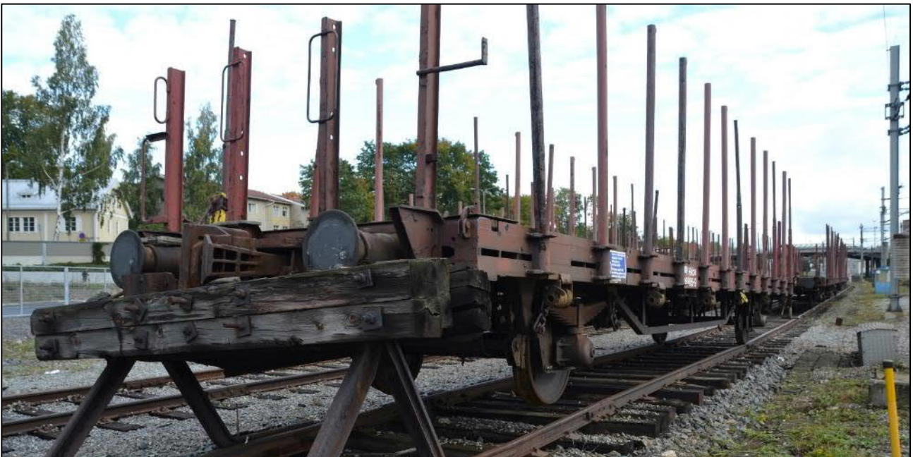
Kuva 5. Hkba-välivaunu törmäyksen jälkeen 25.9.2019. (Kuva: OTKES)
