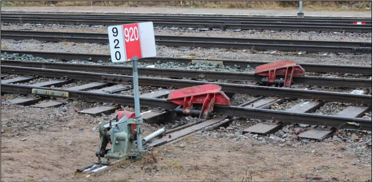
Kuva 27. Raiteensulku ja raiteensulun merkki. Kuvassa raiteensulku on liikennöinnin estävässä asennossa. Kuvassa oleva raiteensulku on kahdelle vierekkäiselle raiteelle. (Kuva: OTKES)
