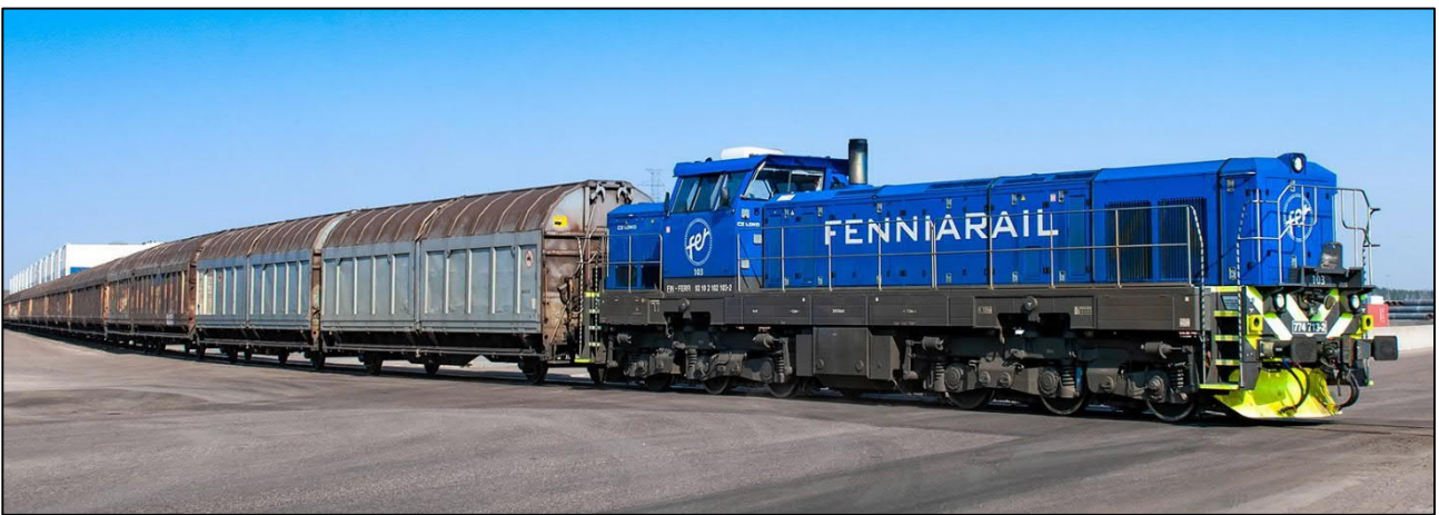
Kuva 32. Fenniarailin Dr18-veturi vetämässä Laais-siirtokatevaunuista koostuvaa junaa. (Kuva: Fenniarail)
