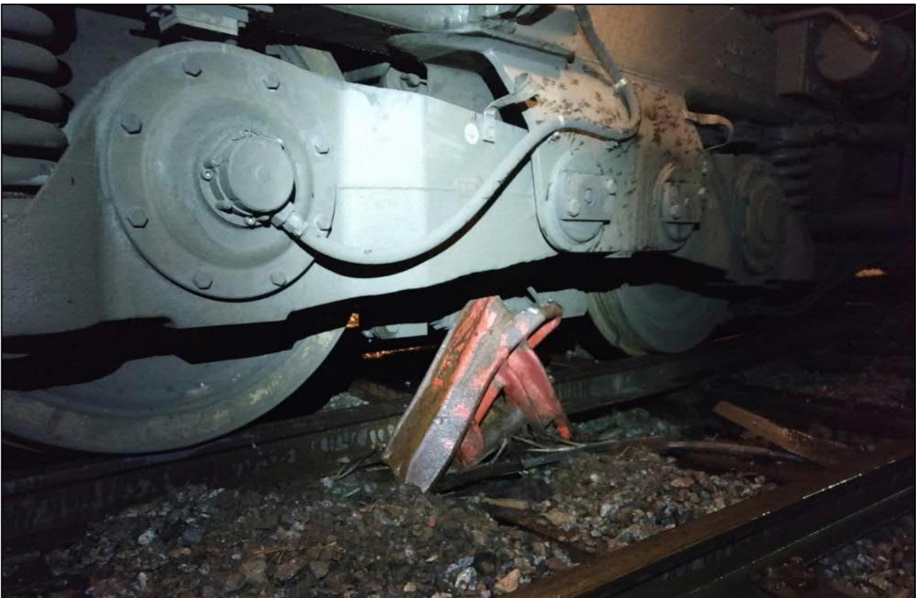
Kuva 7. Raiteensulku kiillautuneena veturin telin alle 8.10.2019. (Kuva: Fenniarail)
