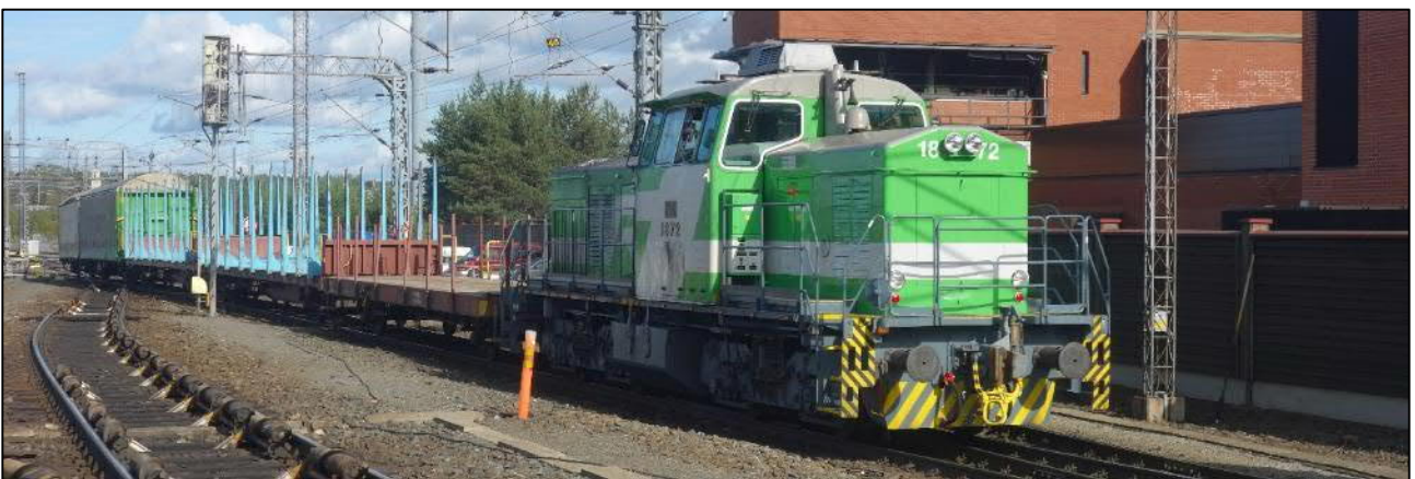
Kuva 30. VR-Yhtymän dieselhydraulinen Dr14-veturi vaihtotöissä Tampereen laskumäessä. (Kuva: OTKES)
