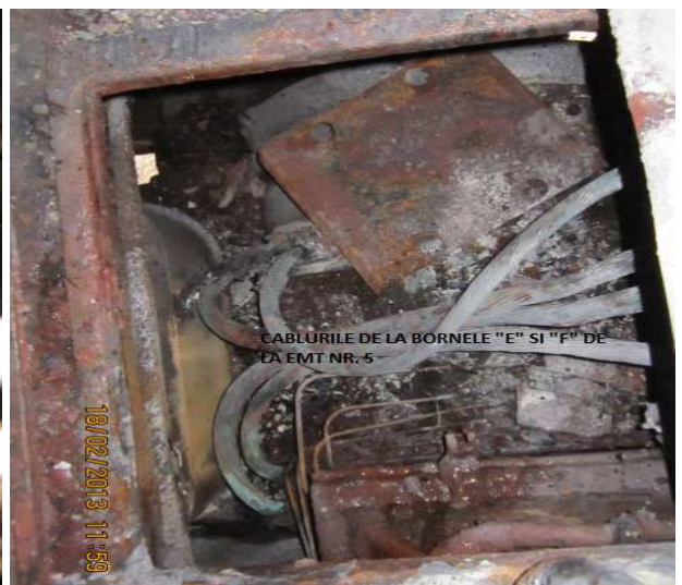
Fig.3 Cablurile de forță de la EMT 4 și EMT 5
