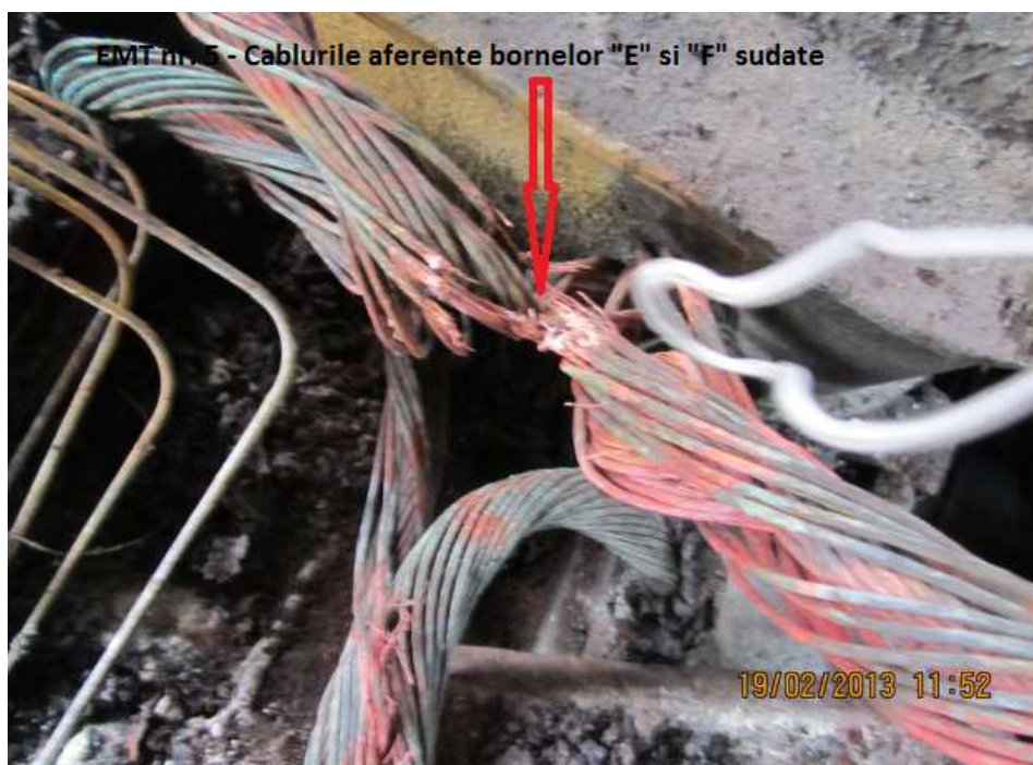
Fig.4 Motorul de tracțiune nr. 5 - Cablurile E și F sudate
