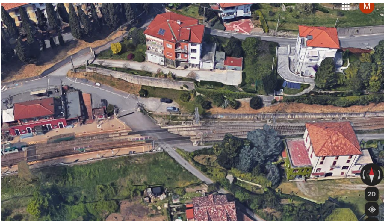
Figura 6 – Foto aerea: partendo da sinistra sono visibili il fabbricato viaggiatori della stazione di Inverigo, il passaggio a livello su Via della Vittoria ed il deviatoio n. 2 prima del binario unico della linea tra le stazioni di Inverigo e Lambrugo/Lurago (fonte: Googlemaps)
