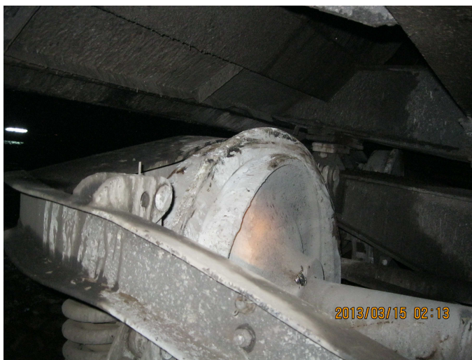
Fig. nr.4 - bandajul roții nr.5 rotit și deplasat transversal
