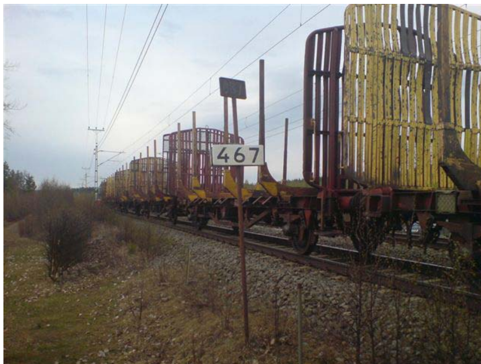
Fig. 1 Foto som visar vagnarna efter att de har stannat. Lägg särskilt märke till gavlarnas utformning som utgör ett vindfång.
