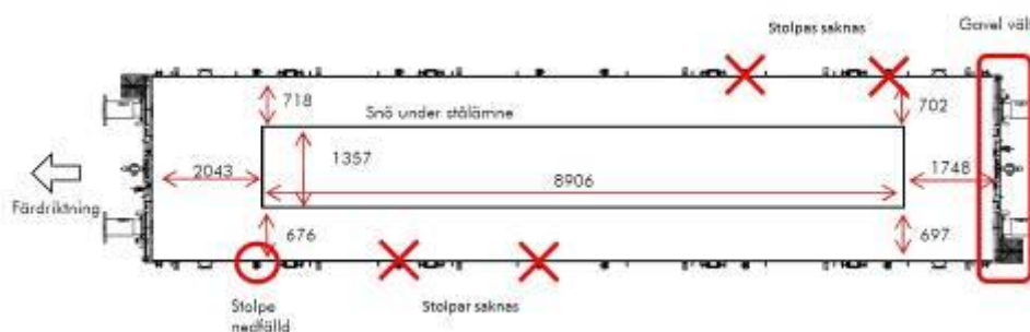
Figur 5. Vagn med tappat stålämne. Måtten är angivna i mm.
