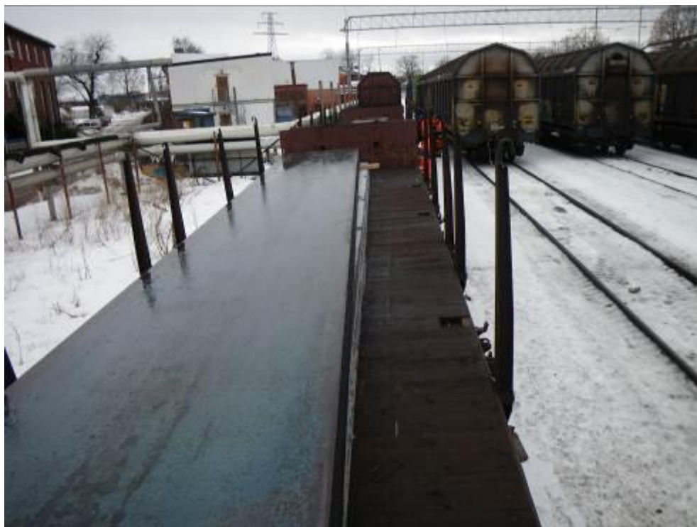
Figur 7. Vagn 33-74-3662-037-7 stålämmena låg osymmetriskt på vagnen.
