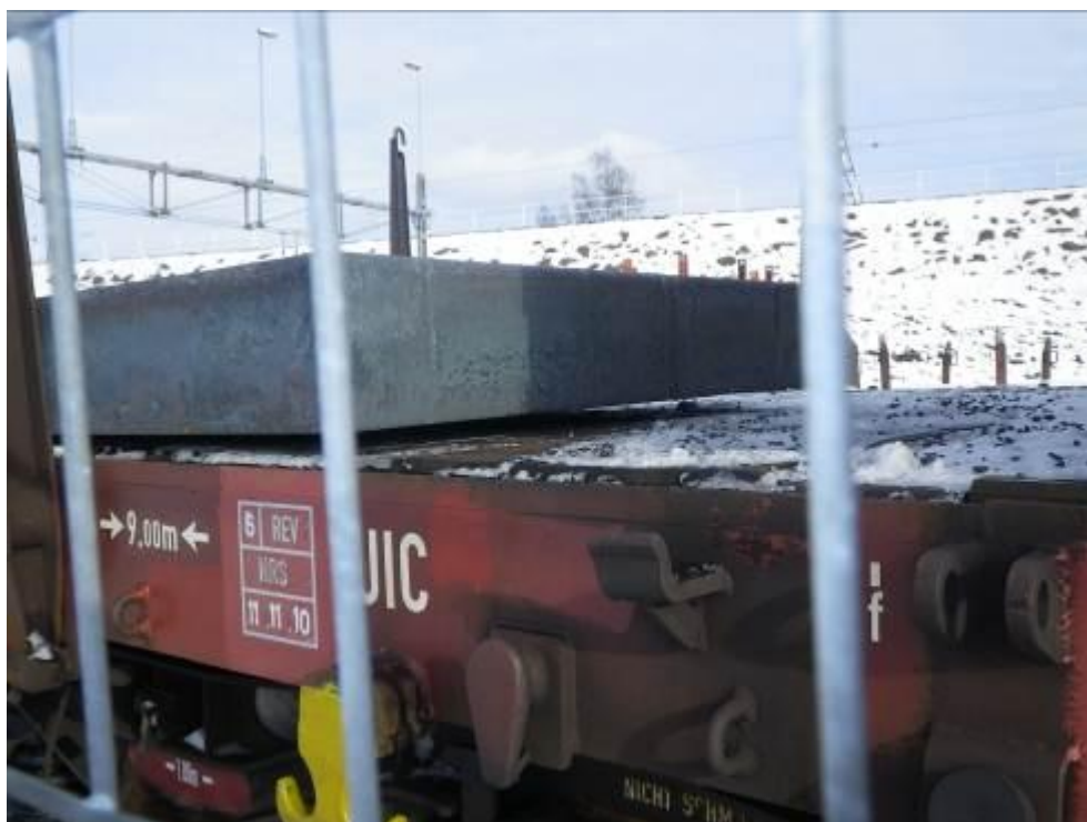
Figur 11. Bild på vagnsgolv med lastat ämne som enligt Oxelösunds Hamn under demonstration var godkänt sätt att lasta på.
