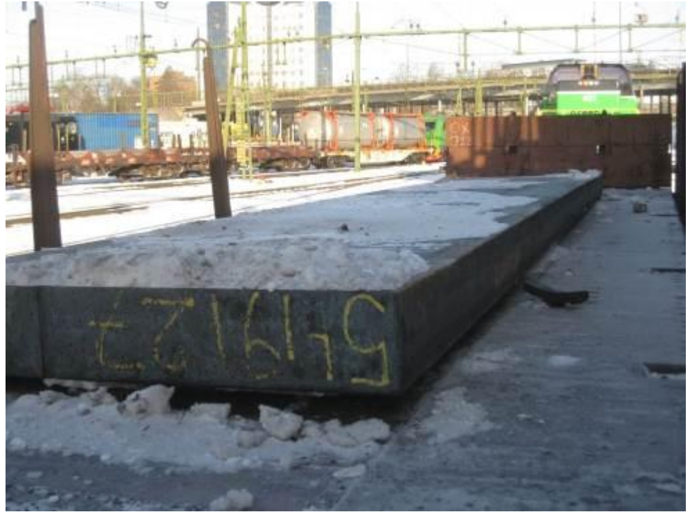
Figur 12. Snö och is under det undre ämnet på vagn 33-74-3662-069-0.
