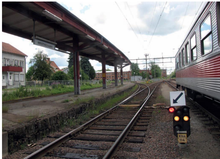
Figur 6. Bilden visar en huvuddvärgsignal i Kristinehamn som är försedd med både en äldre, mindre pilskylt och en större pilskylt i enlighet med den pilskylt som finns föreskriven i JTF. Foto: Trafikverket.
