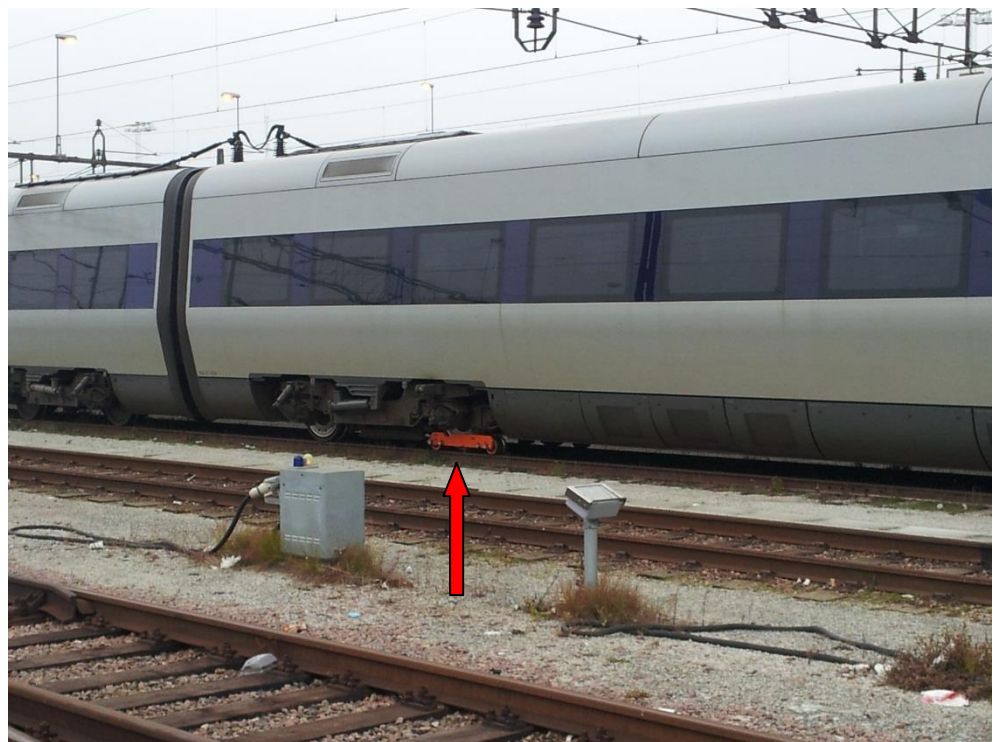
Figur 1. Bild på en axel med en tralla monterad. Foto: ISS Trafficare AB.
