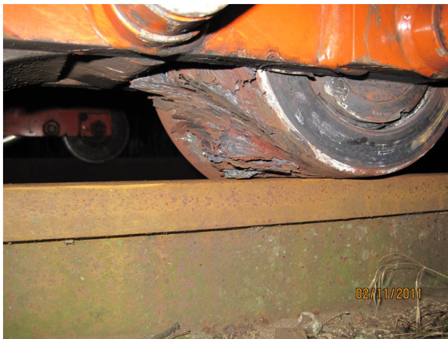
Figur 2. Foto på trallans skadade hjul. Foto: DSB Øresund.
