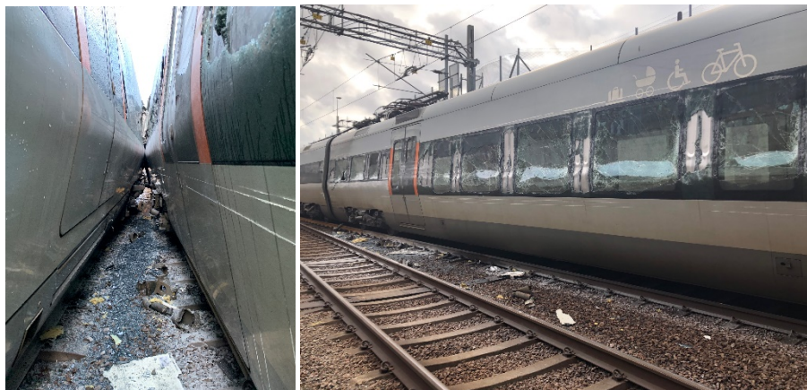
Figur 5. Skador utmed tågets andra vagn. Foto: ISS.
