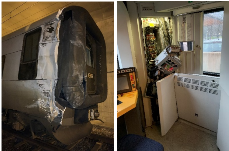
Figur 4. Skador på tågets front och i förarhytten. Foto: ISS.
