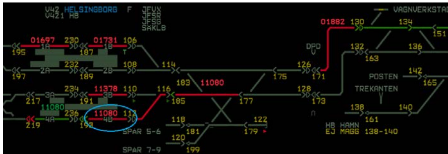
Figur 15. Klockan 18.49.50 belägger resandetåget spårledningen bakom msi 112 in på spår 4B (blå ring).
