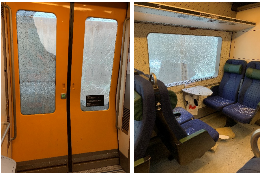
Figur 6. Krossade glasrutor inne i tåget. Foto: ISS.
