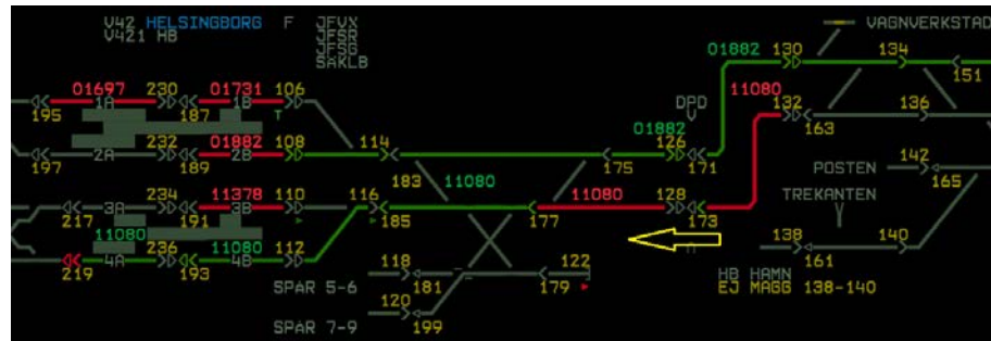
Figur 12. Vid tidpunkten 18.48.58 indikerar manöverloggen att resandetåget passerade msi 173 (gul pil). Växlingsrörelsen hade vid detta tillfälle ännu inte passerat dvti 110.
