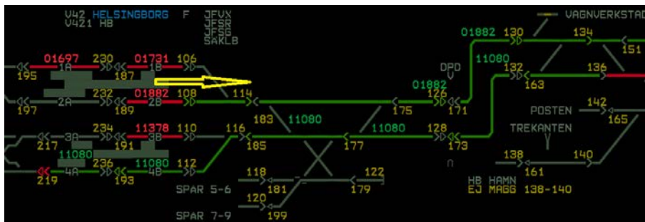
Figur 10. Klockan 18.48.05 ställdes tågväg för tåg 1882 söderut från spår 2 (gul pil). Dvärghälsningarna 108 och 114 står parallellt med motsvarande dvti 110 och 116 för spår 3.
