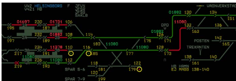
Figur 11. Vid tidpunkten 18.48.45 visar manöverloggen att ställverket magasinerade (planerade för) en växlingsväg från spår 3B till spår 8 efter att resandetåget ankommit spår 4 (på videofilmen blinkar pilarna i de gula ringarna).
