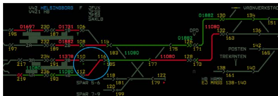
Figur 13. Klockan 18.49.02, fyra sekunder efter att tåget hade passerat msi 173, indikeras att växlingsrörelsen passerade dvti 110 (spårledningen för växeln mellan spår 3 och 4 indikeras rött i den blå ringen).
