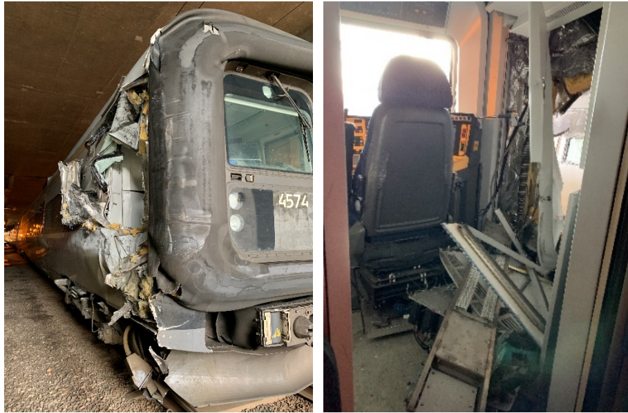
Figur 3. Skador på växlingsrörelsens front och i förarhytten. Foto: ISS.
