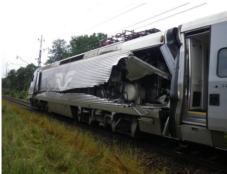
Figur 13. Bild på skador på drivenheten.
