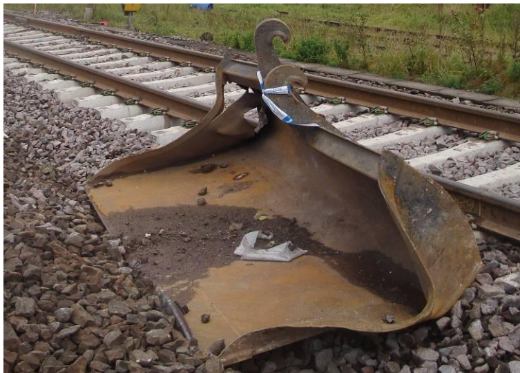
Figur 12. Bild på den skadade frontskopan.
