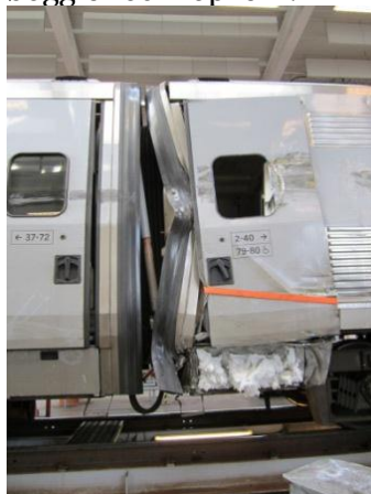
Figur 26. Bild på skador på gaveldörr.
