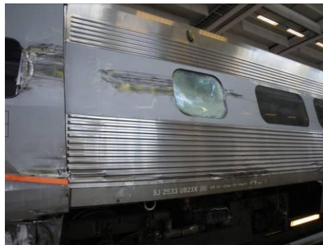
Figur 27. Bild på utvändiga skador vid WC.
