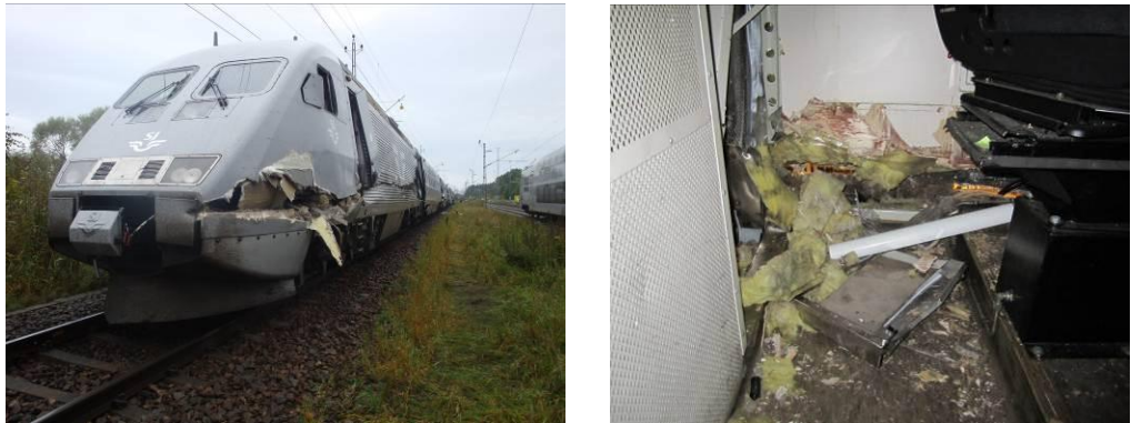
Figur 14. Skador på förarhytt ut- och invändigt
