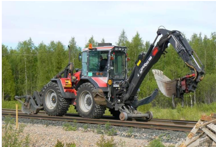
Figur 30. Bild på en Huddig 1160. Fordonet på fotot har inte frontskopa monterad. Bilden är taget av Alexander Lipkin.
