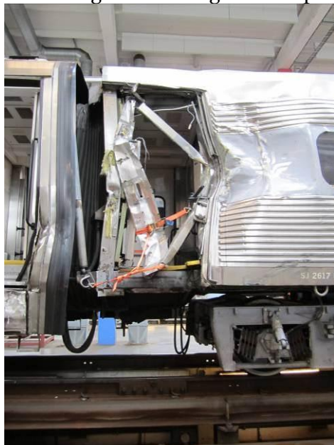
Figur 24. Bild på skador på dörr 1 på vagn 2617.
