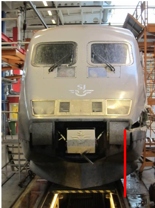
Figur 15. Bild på fronten på drivenheten. Skopan har skurit in nästan i jämnhöjd med vänstra rälen i färdriktningen.
