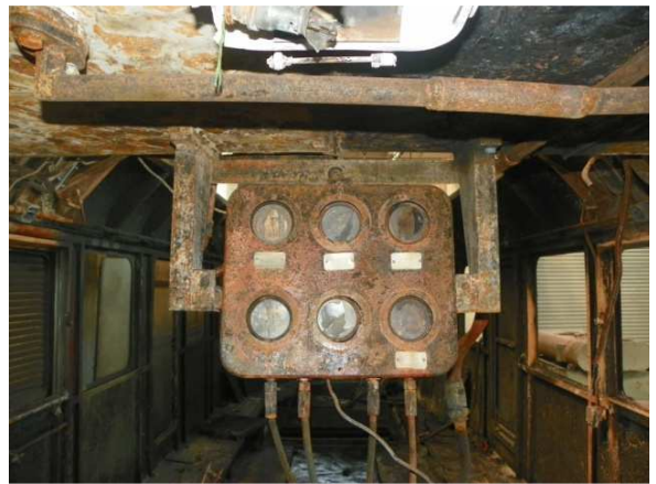
Fig.2 Panou aparate supraveghere a motorului diesel
