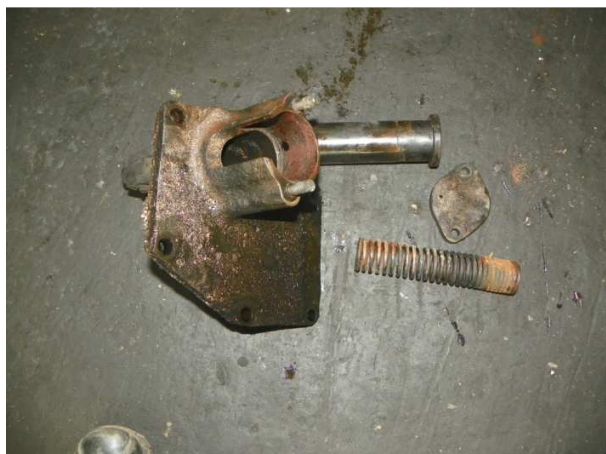
Fig.13 Ansamblu protector supraratare motor diesel demontat
