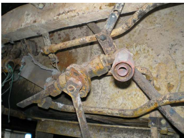
Fig.5 Robinetul cu trei căi poz.541 cu armătură superioară racord flexibil
