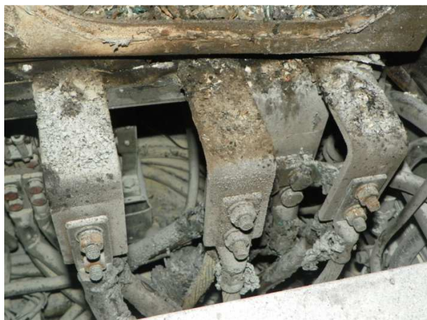
Fig.14 Cablaj de forță aferent releelor de curent maximal poz.54.1-3
