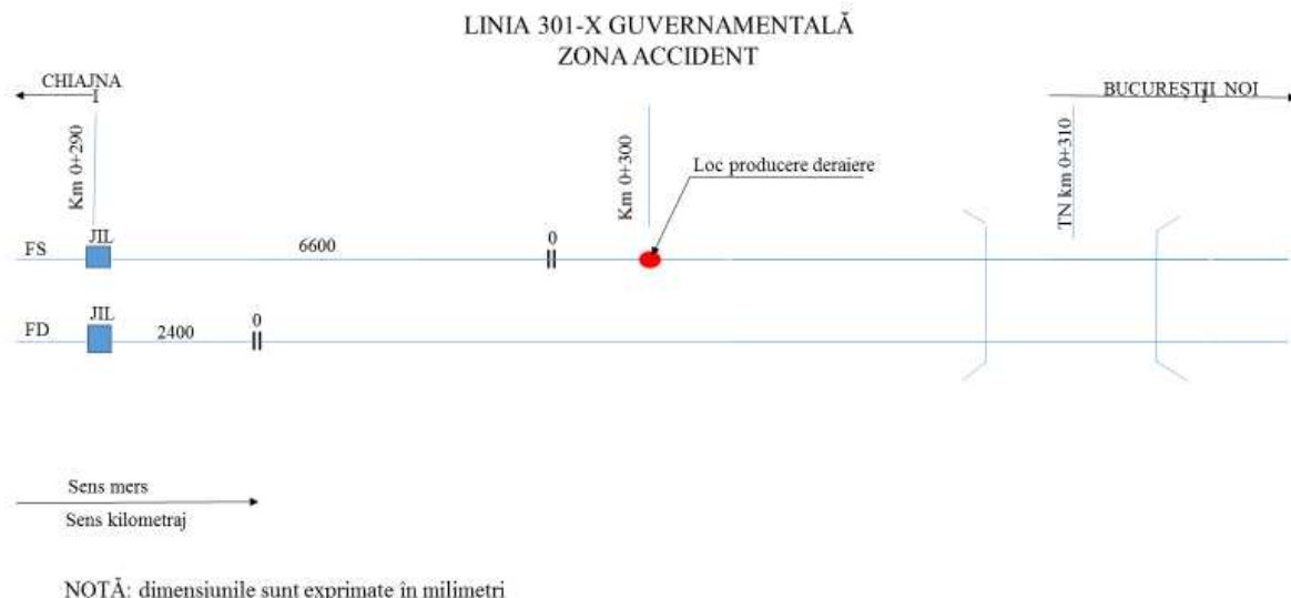
Fig. 9 – schița cu poziția joantelor în zona accidentului
