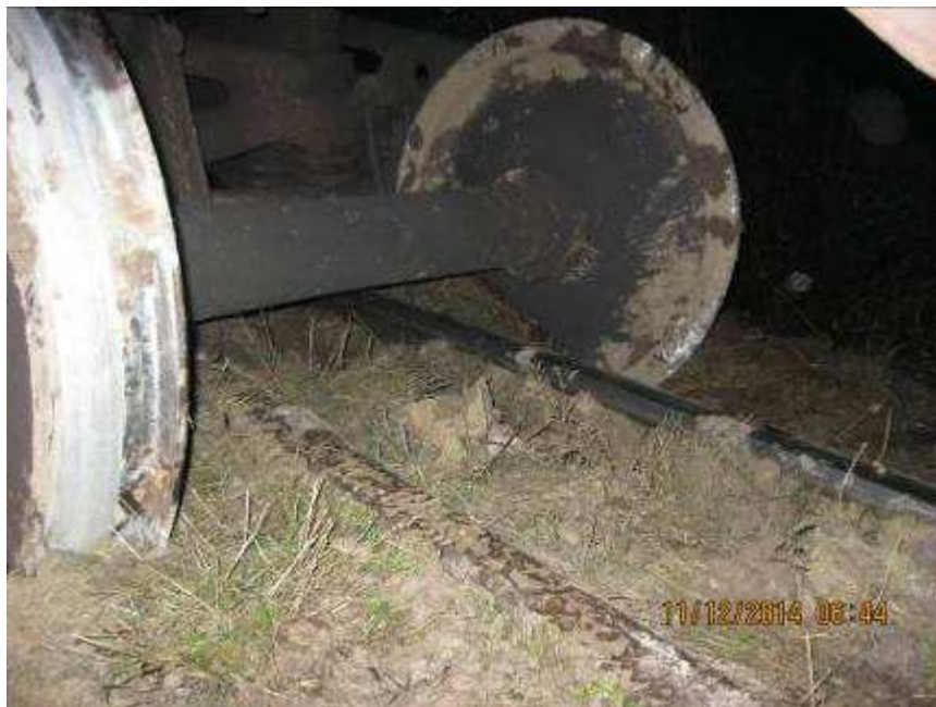
Foto nr.5 Prima osie a vagonului al 4-lea, deraiată în partea stângă în sensul de mers, prin escaladarea firului exterior al curbei, la o distanță față de șină de 0,75m
