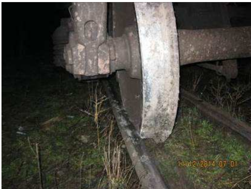
Foto nr.7 Ultima osie, a vagonului al 6-lea, deraiată cu roata din stânga, în sensul de mers, căzută între firele căii, lângă șina corespunzătoare firului exterior al curbei
