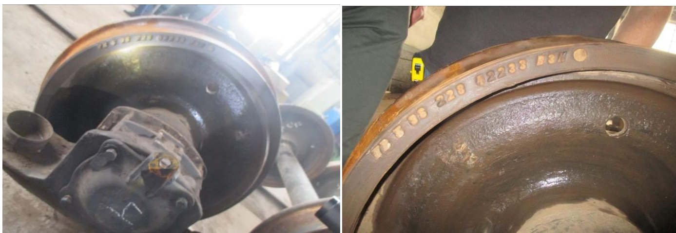
Foto nr.4 – marcajele de roata nr.4 (cu bandajul deplasat axial) care a produs deraierea
