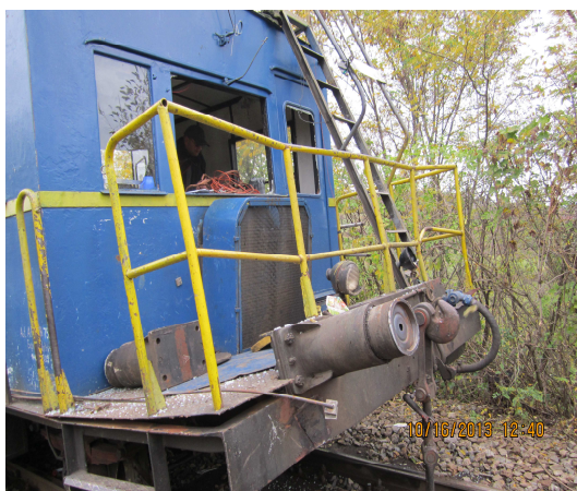
Fig. nr.2: Urmările coliziunii dintre DP58 și vagonul de marfă
