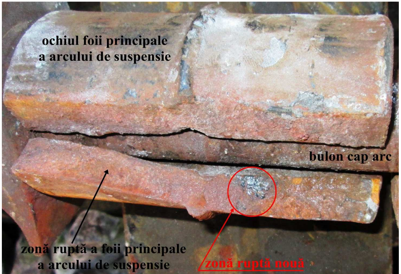
Fotografia nr.5 – Aspectul zonei rupte pe ochiul foii principale a arcului de suspensie
