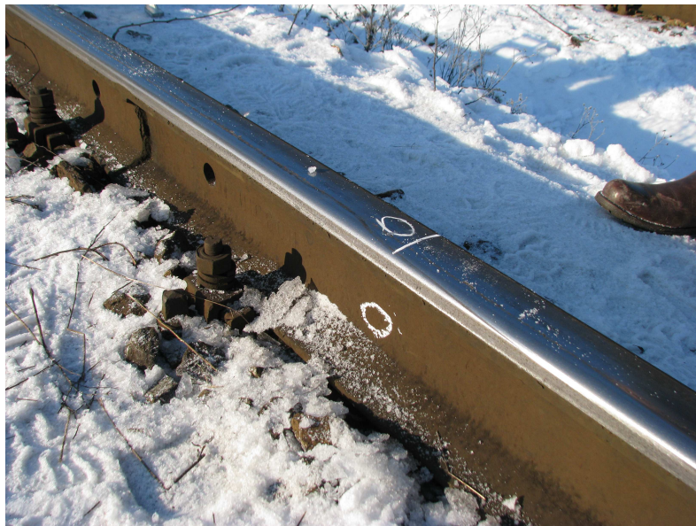
Foto nr.6: Urma de escaladare (punctul 0) a șinei din dreapta de către buza bandajului roții din dreapta a primei osii
