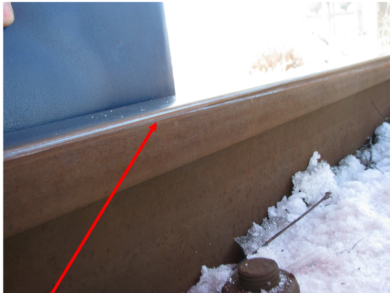
Foto nr. 5: Prima urmă de deraiere (punctul 0' ) aflată pe flancul activ al șinei din stânga
