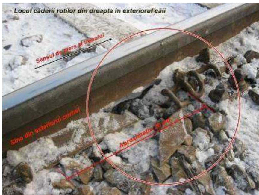
Foto nr.3 – punctul de reper „1”, ruptura tălpii șinei exterioare
