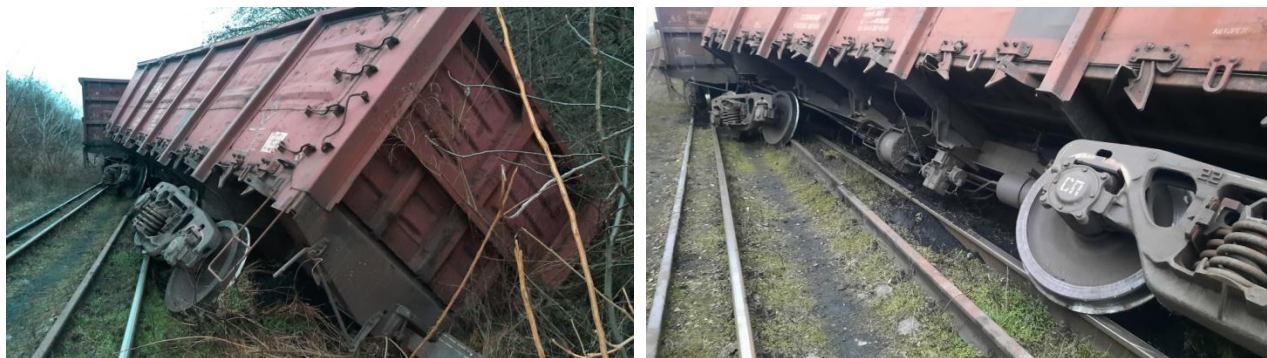
Foto nr.1 - vagonul nr.52277464 - după deraiere și răsturnare
