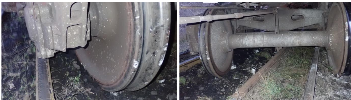
Foto nr.2 - boghiul al 2-lea al vagonului nr.63340459 - după deraiere
