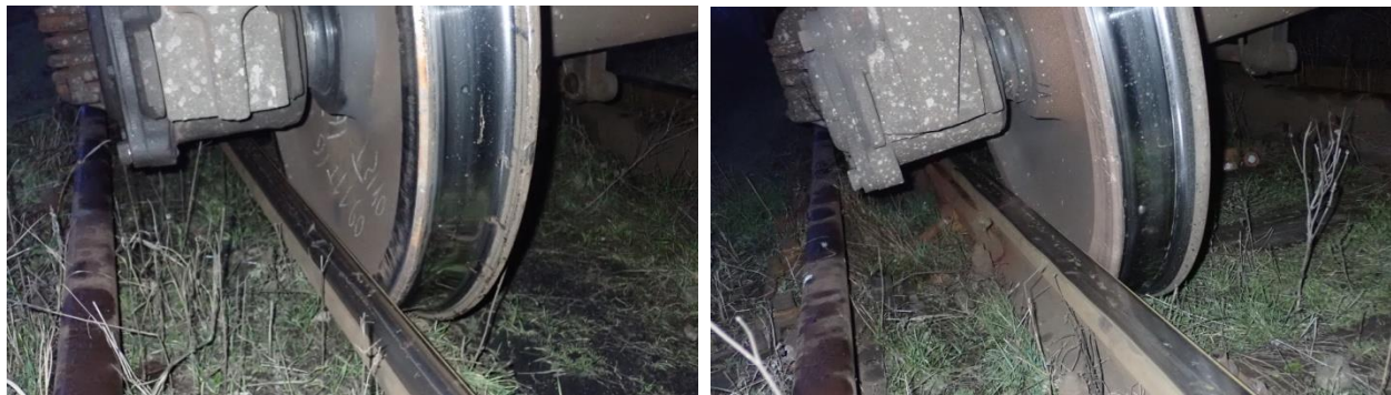
Foto nr.3 - vagonul nr.61517355- după deraiere
