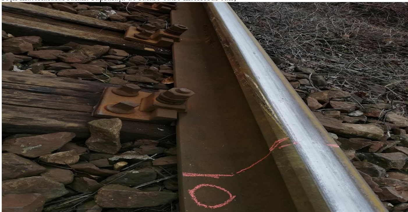
foto 5: urme de frecare specifice căderii roții în interiorul căii (zona punctului 0)
