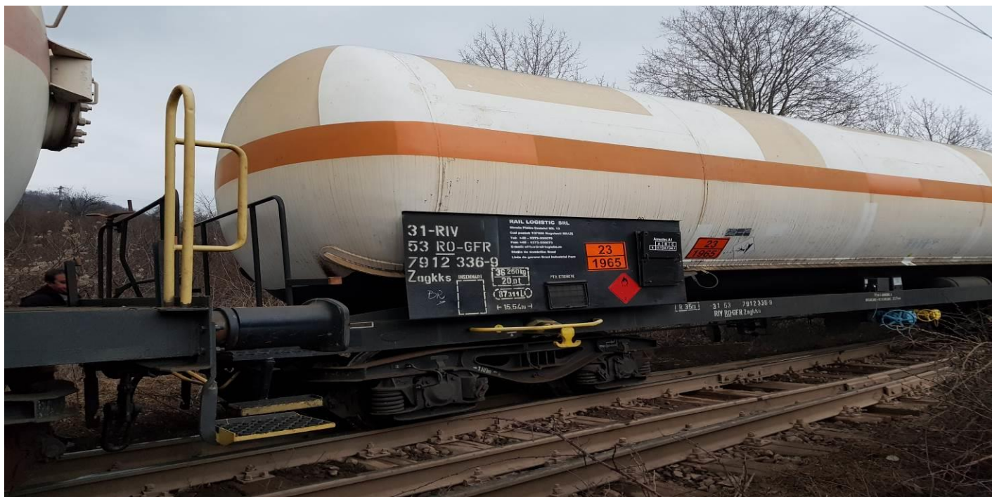
foto 1: poziția boghiului II al vagonului, după deraiere
