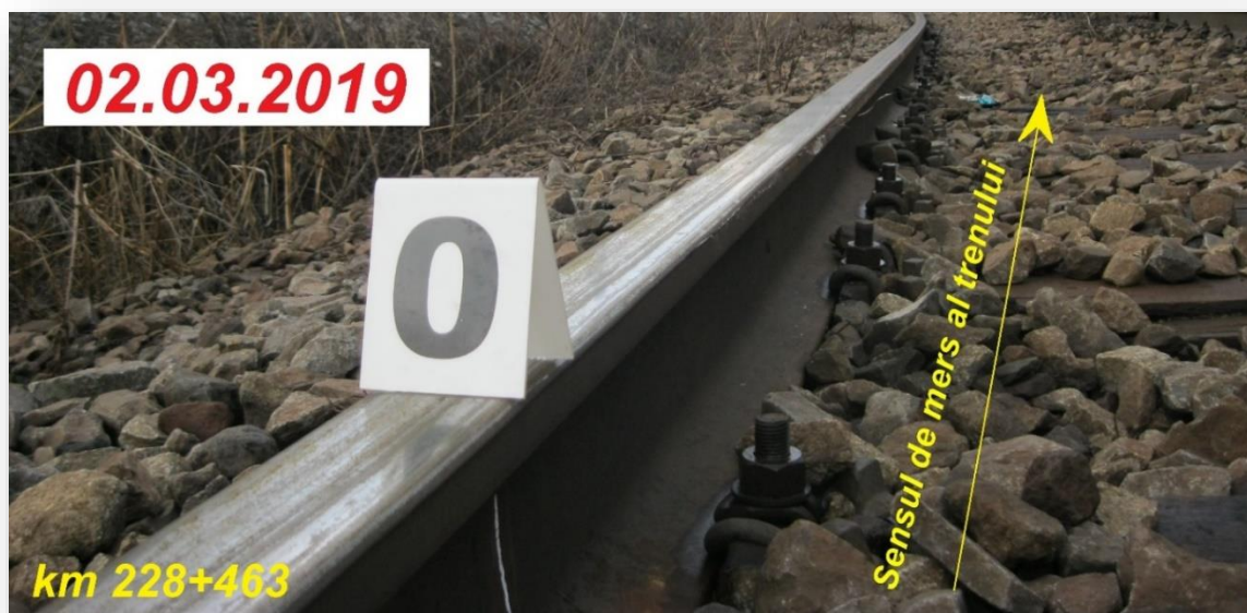
Foto nr. 4 – Prima urmă de deraiere. Punctul de cădere a roții din stânga a primei osii în sensul de mers, între firele de șină ale căii
