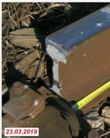
Foto nr.9 ÷13 – Secțiuni de rupere a șinei din cale
