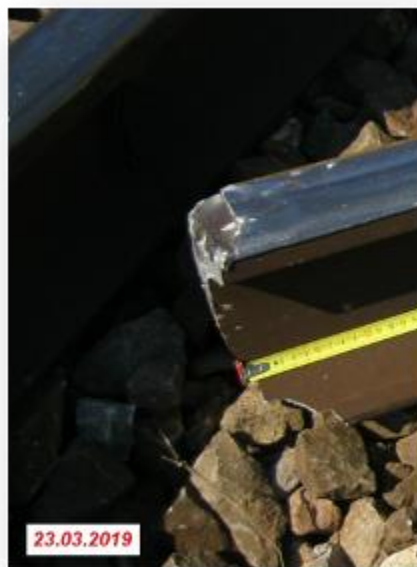
Foto nr.9 ÷13 – Secțiuni de rupere a șinei din cale
