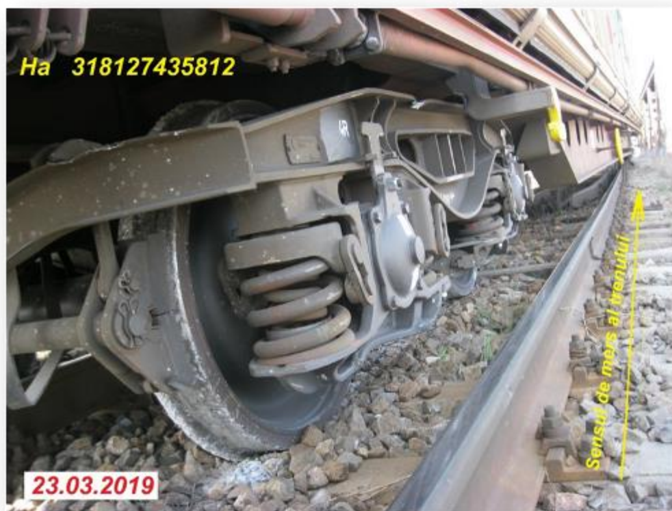
Foto nr.3 - Poziția boghiului nr.2, deraiat, după oprirea trenului
