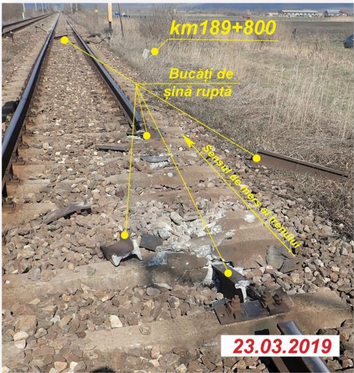
Foto nr.5 - Bucățile de șină ruptă (pozițiile în care au fost găsite de comisa de investigare)
