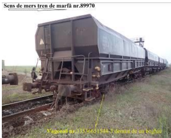
Fig. nr.8 - vagonul nr. 33536651544-3 : osiile cu roțile \frac{1}{2} și \frac{3}{4} deraiate
