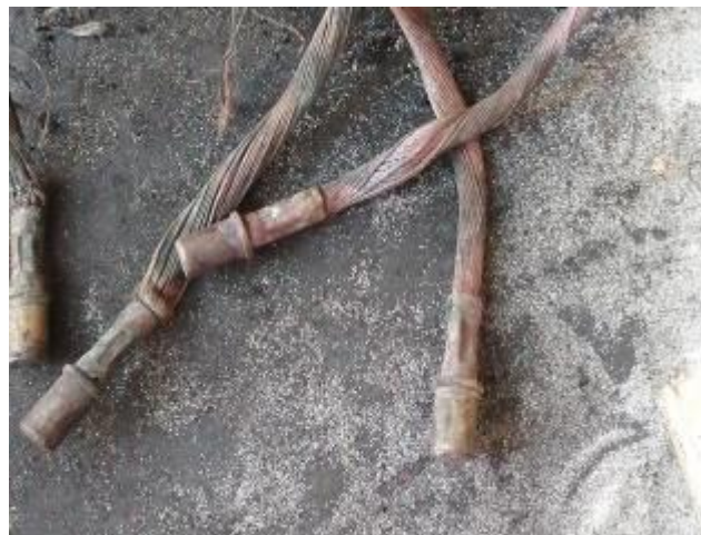
Foto nr.8 conectorii tip tulpă (T) supraîncălziți
