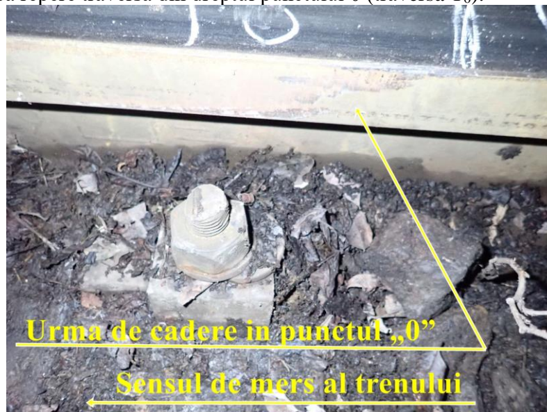
Foto nr.4 – urma de cădere a roții între firele căii
