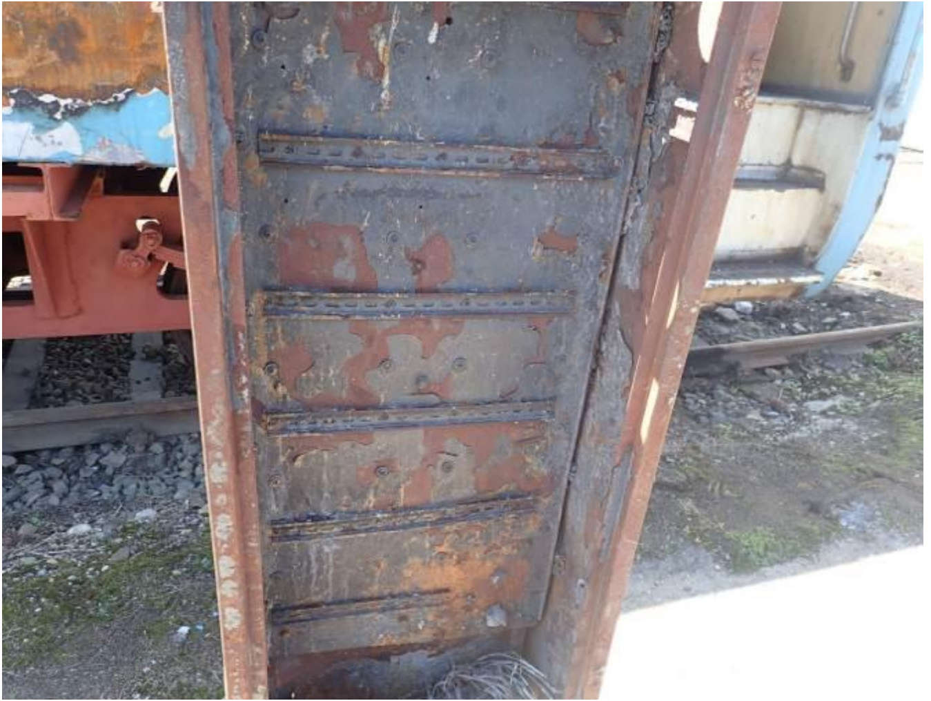
Foto nr.8–Carcasa în care se afla tabloul de siguranțe electrice și rele – scoasă din cabina automotorului
