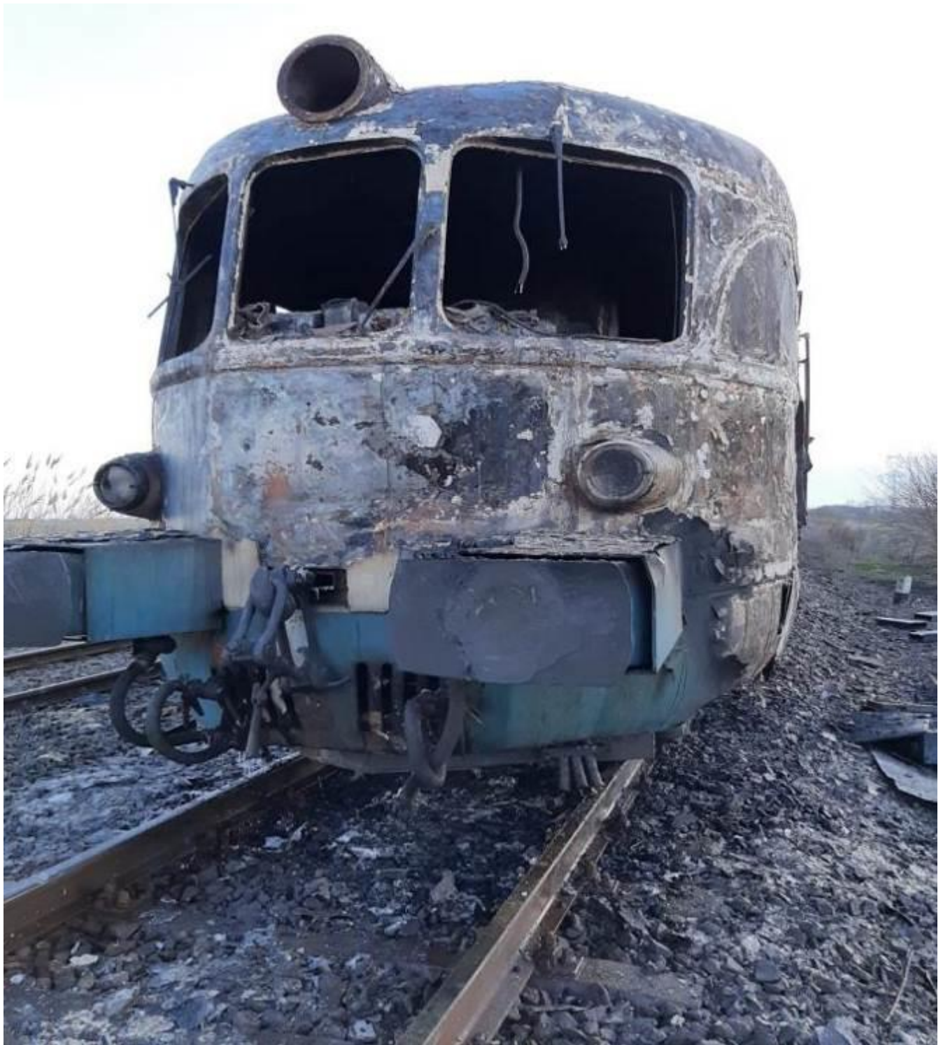
Foto nr.3–Automotor 1017 - postul de conducere (inactiv) de unde a izbucnit incendiul
