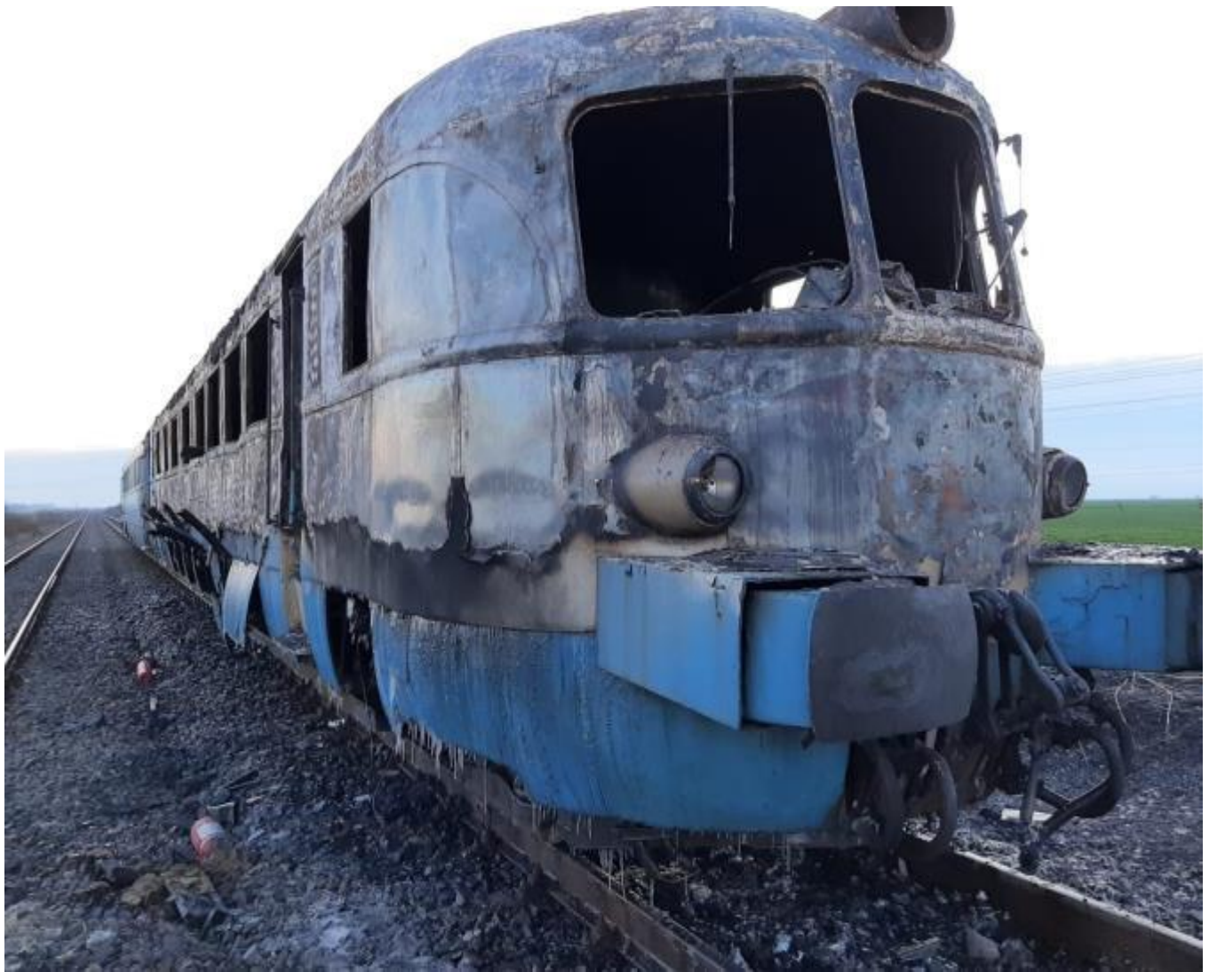
Foto nr.1–Vedere din spate a cuplului de automotoare 1919/1017 după detașarea și distanțarea cuplului 1008/1009. Postul de conducere inactiv de unde a izbucnit și s-a propagat incendiul.
