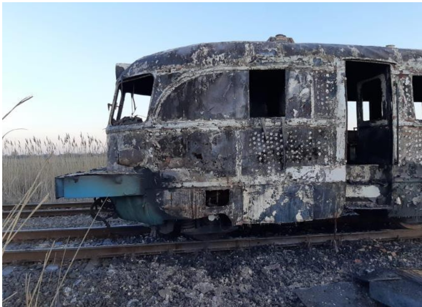
Foto nr.2–Automotor 1017 – postul de conducere (inactiv) de unde a izbucnit incendiul
