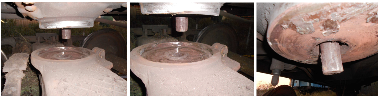
Foto nr.3 Crapodinele inferioară și superioară ale vagonului
