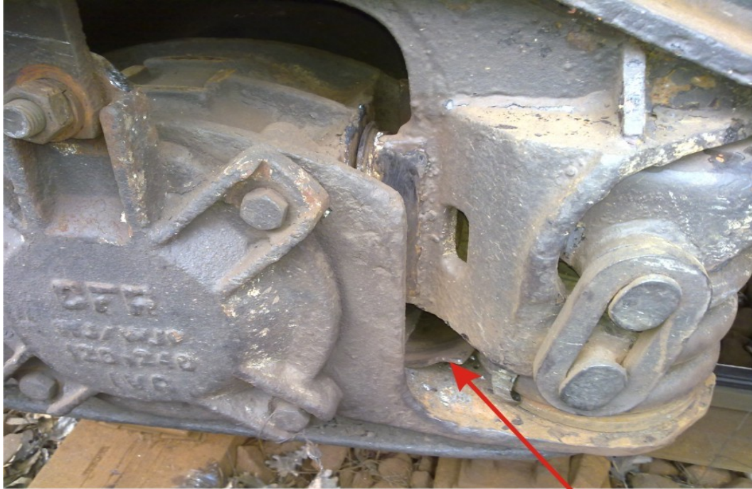
plăcuță de oțel manganos deformată
