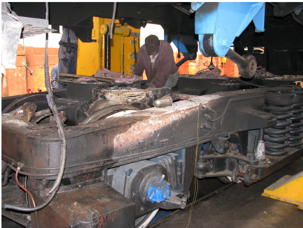
Foto 11 - rama boghiului II prezintă urme de ardere în partea superioară, în zona MET 4
