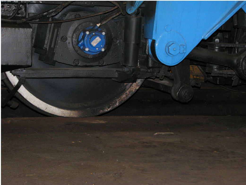
Foto 12 - bandajele de la roțile osiilor 3 și 4 prezintă urme de fum
