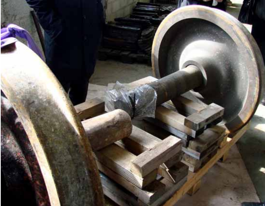
Photo 1 : vue générale de la rupture de l'essieu.
