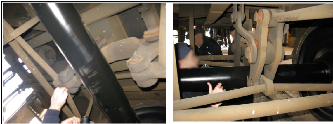
Figure 17 : Examen de la timonerie d'un wagon Laaips
