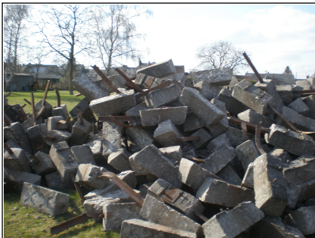
Figure 4 : Traverses de la voie 2 bis détériorées lors du déraillement
