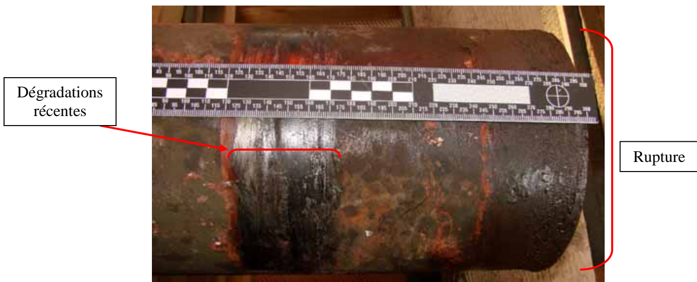
Photo 1 : dégradation sur le corps de l'essieu côté gauche de la rupture.
