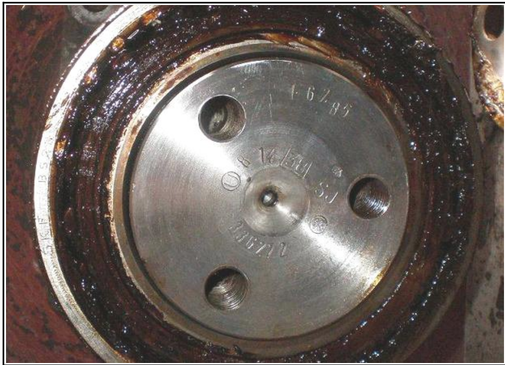
Figure 13 : Marquages de l'axe de l'essieu rompu
