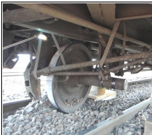
Figure 12 : Le demi-essieu resté sous le wagon
