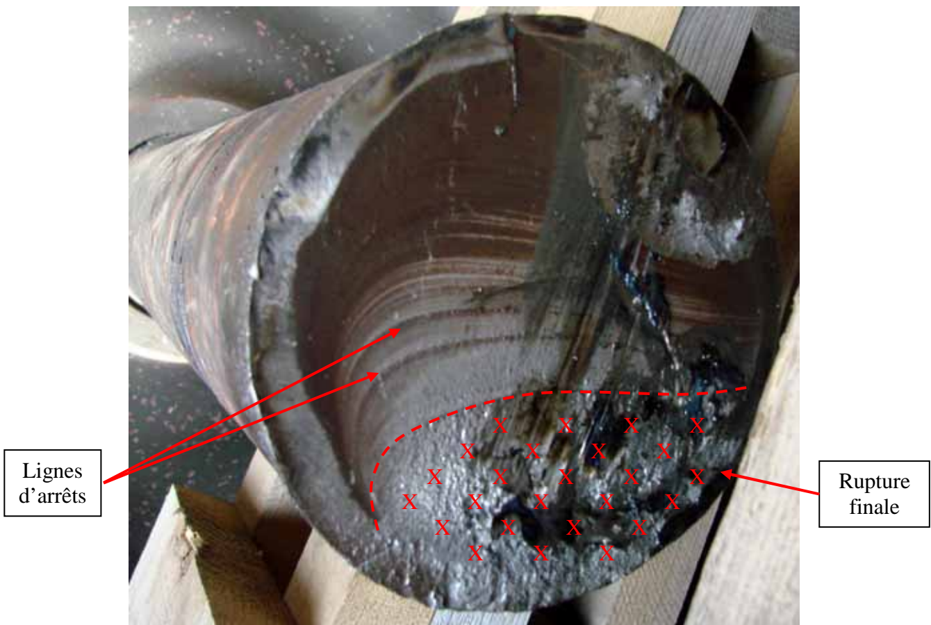
Photo 4 : faciès de rupture.
