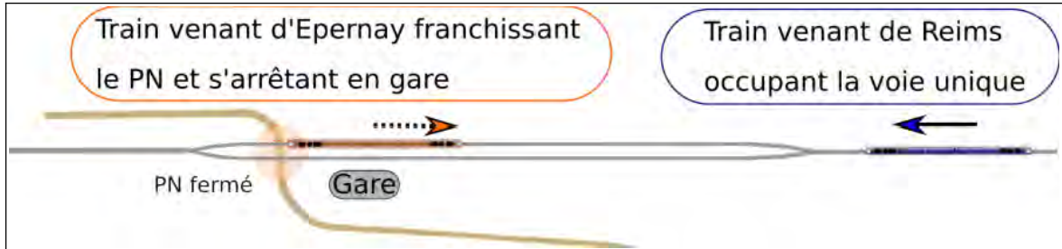
Figure 18 : schéma illustratif de la situation 2 avec un train en provenance d'Épernay franchissant le PN fermé, le train venant de Reims occupe la voie unique.
