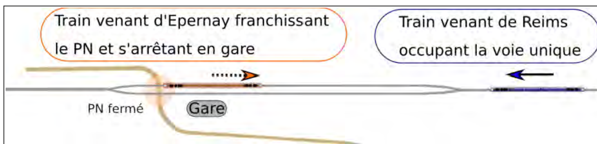
Figure 25 : schéma illustratif de la situation 3-b avec un train en provenance d'Épernay franchissant le PN fermé, le train venant de Reims occupe la voie unique.
