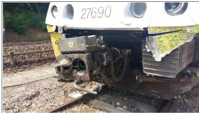
Figure 43 : vue sur les dégâts sur le nez de la motrice de tête (photo SNCF)
