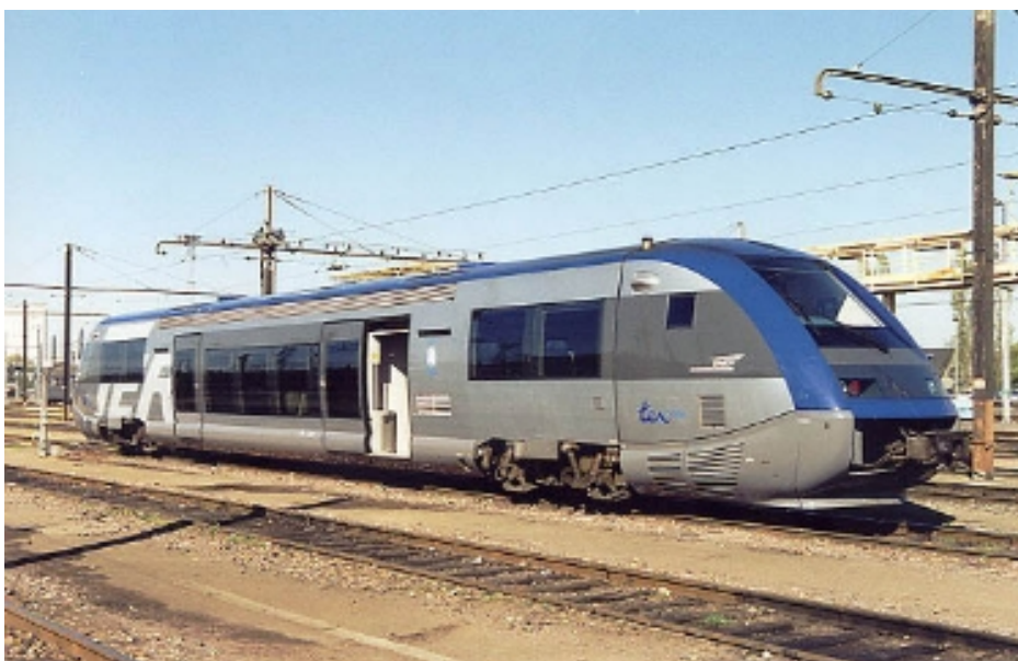
Fig. 5 : Autorail Alstom de type X73500
